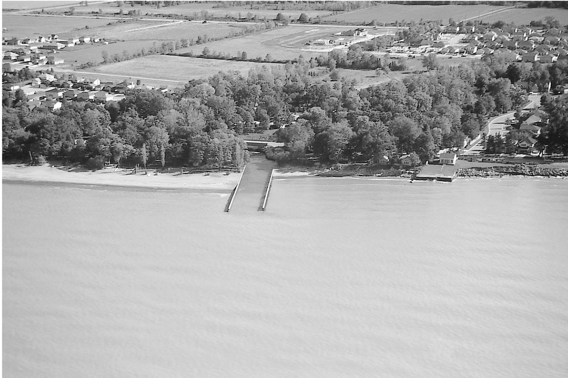
palplanches d'acier. Le brise-lames Est est plus long et porte un **feu** orange. La zone comprise entre les brise-lames assèche au zéro des cartes (1998).
