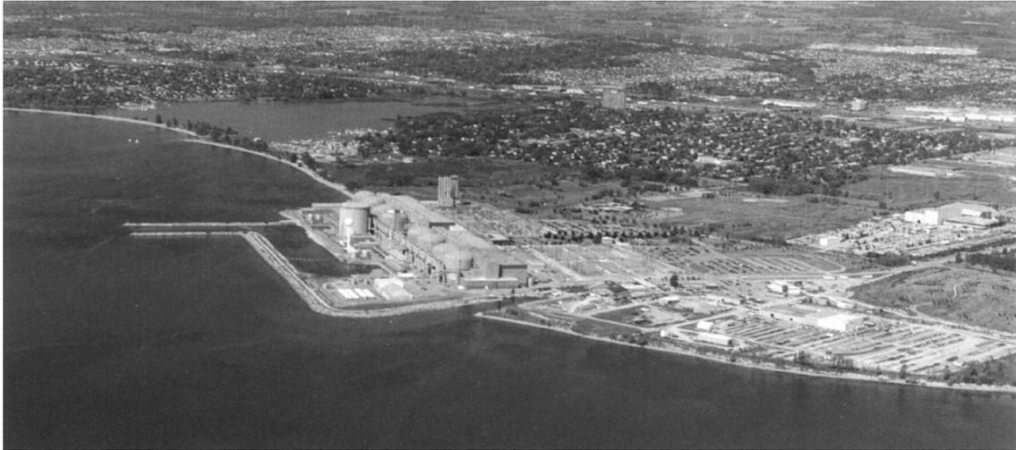
distance dans l'Est. La baie s'ouvre entre deux brise-lames parallèles distants de 30 m (100 pi) et qui s'avancent de 122 m (400 pi) dans le lac. Une plage sablonneuse déborde la rive dans l'Ouest depuis l'entrée de la baie.
