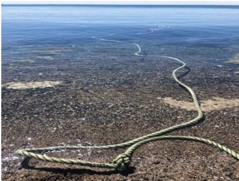
Figure 4. Photo du même cordage qu'à la figure 3 illustrant la flottabilité positive de celui-ci. L'irrégularité de la ligne est une boucle serrée (source : E. Trippel).
