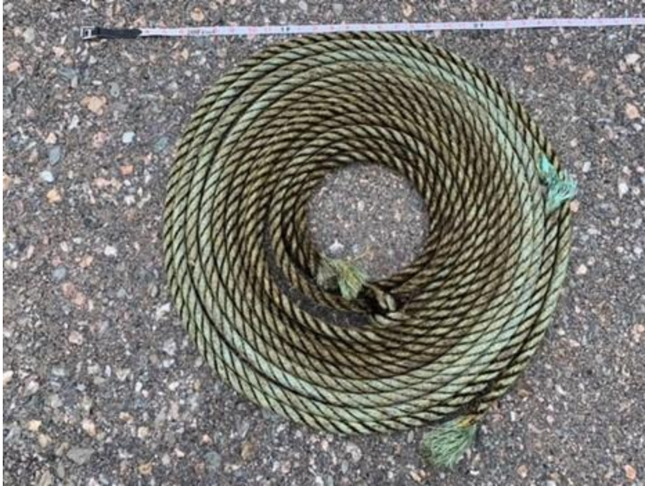
Figure 3. Section de 14,5 m (47,5 pi) du cordage vert pâle à flottabilité positive de 5/8 po de diamètre retiré de Snow Cone le 11 mai 2021 dans le sud du golfe du Saint-Laurent (source : U. Brideau).
