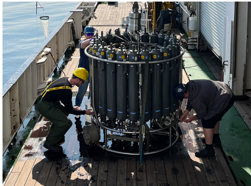
Une rosette qui mesure la conductivité, la température et la profondeur utilisée dans le cadre du Programme de monitoring de la zone Atlantique. Crédit photo : MPO.
