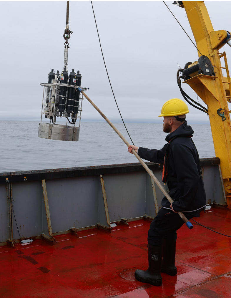
Déploiement d'une rosette de conductivité, de température et de profondeur aux fins du suivi des conditions océanographiques dans la ZPM. Crédit photo : MPO.
