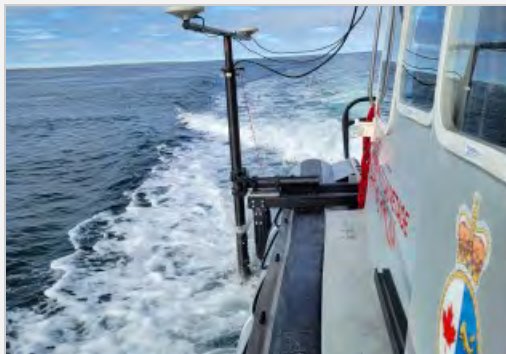
Sonar (Norbit) monté sur pôle.
