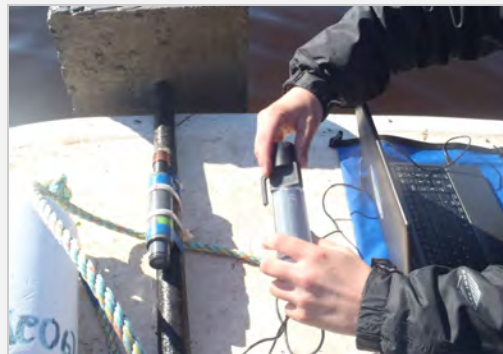
Sonde d'oxygène dissous sur son mouillage
