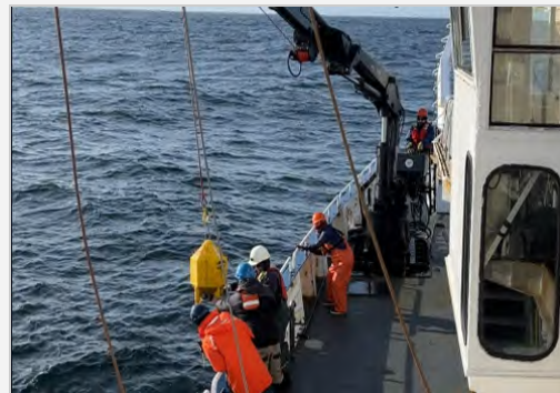
Récupération d'un récepteur de télémétrie acoustique.
