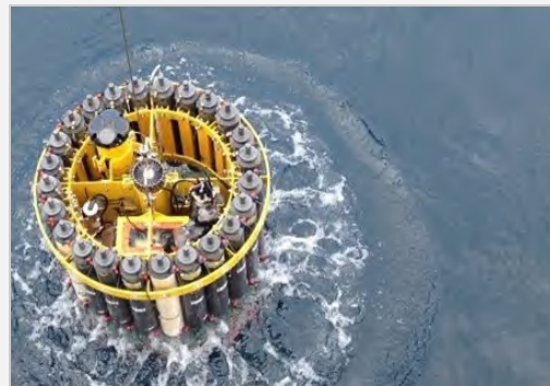
CTD-Rosette (conductivité, température, profondeur) en cours de déploiement. © Pêches et Océans Canada
