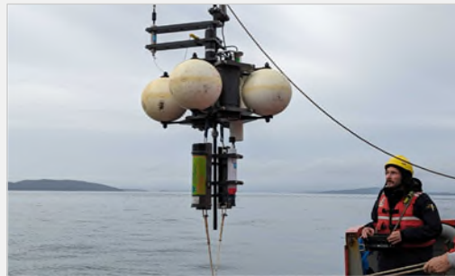
Déploiement d'une bouée acoustique depuis le NGCC Vector. © Seth Fleming-Alho (Pêches et Océans Canada)
