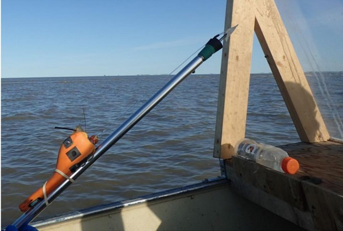
*Figure 5. Le prototype d'ancre à tête mobile Inuvik Dart de Wildlife Computers est monté sur une perche télescopique en aluminium et fixé à un émetteur SPLASH10-F-321 de Wildlife Computers. Source de la photo : Lisa Loseto.*
