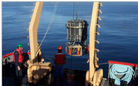
Installation d'une rosette, un appareil d'échantillonnage en eau profonde. © Pêches et Océans Canada
