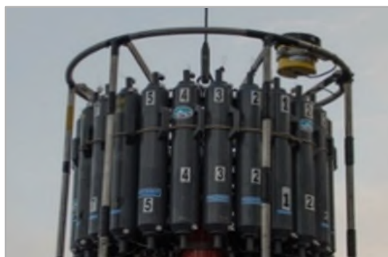
Déploiement d'une rosette, un appareil d'échantillonnage en eau profonde. © Pêches et Océans Canada
