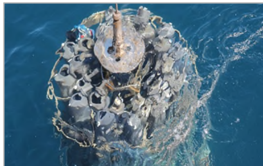
Déploiement d'une rosette, un appareil d'échantillonnage en eau profonde.
