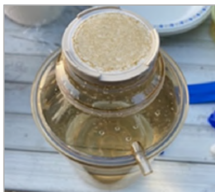
Filtration de l'eau de mer pour l'analyse des biotoxines. © Nicole Frederickson (Fondation du saumon du Pacifique)
