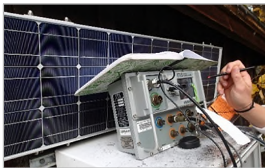
Installation d'un enregistreur de température de l'eau en temps réel dans la rivière Stuart.
