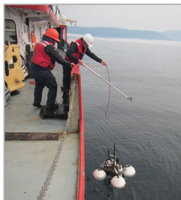
Récupération d'un amarrage à bord du Vector. © Pêches et Océans Canada
