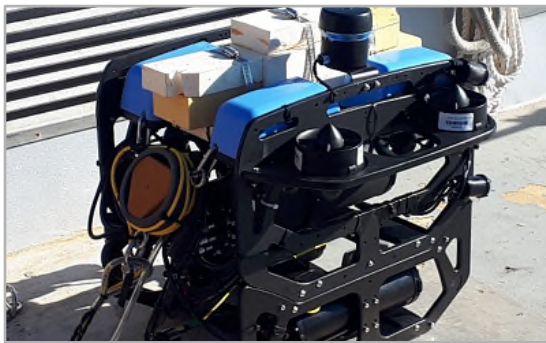
Le « Blue ROV2 » est utilisé pour étudier les sites d'ancrage.
