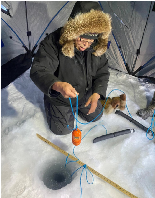
Gauche : David Putumiraqtuq déploie des appareils sur la glace de mer près d'Igluligaarjuk (Chesterfield Inlet) pour mesurer la température et la salinité de l'océan. Photo : Darcy McNicholl, MPO. Droite : Déploiement d'appareils pour surveiller les conditions océaniques et biologiques pendant toute une année dans l'ouest de l'Arctique canadien. Photo : Andrea Niemi, MPO.
