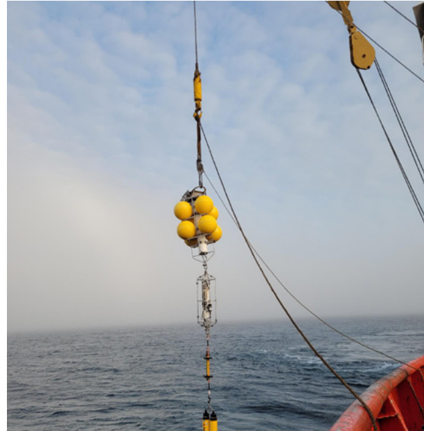
Gauche : David Putumiraqtuq déploie des appareils sur la glace de mer près d'Igluligaarjuk (Chesterfield Inlet) pour mesurer la température et la salinité de l'océan. Photo : Darcy McNicholl, MPO. Droite : Déploiement d'appareils pour surveiller les conditions océaniques et biologiques pendant toute une année dans l'ouest de l'Arctique canadien. Photo : Andrea Niemi, MPO.
