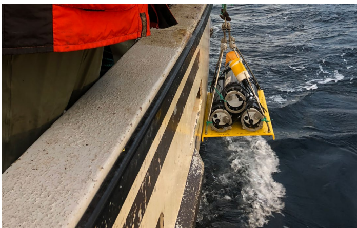
Déploiement du « Bottom Mooring System » (système d'amarrage de fond) de JASCO. Crédit : Pêches et Océans Canada.
