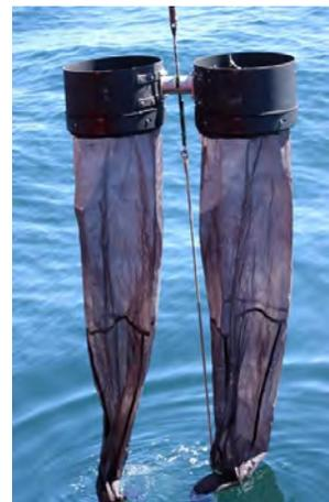
**Image 2 :** Filets de type « Bongo » utilisés pour échantillonner le zooplancton.
