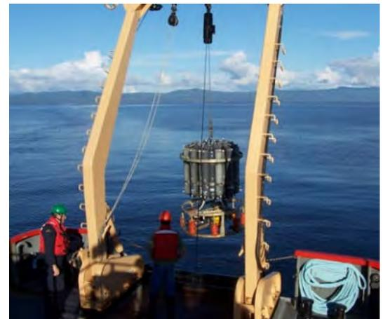
**Image 2 :** Installation d'une rosette, un appareil d'échantillonnage en eau profonde.
