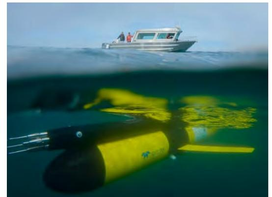
**Image 2 :** Photo sous-marine du planeur Mike en train de prélever des échantillons.
