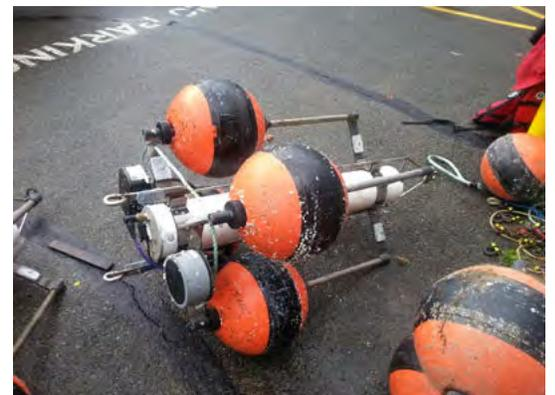
**Image 2 :** Amarrage acoustique avant déploiement.
