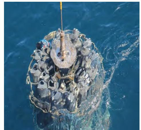
**Image 2 :** Déploiement d'une rosette, un appareil d'échantillonnage en eau profonde.
