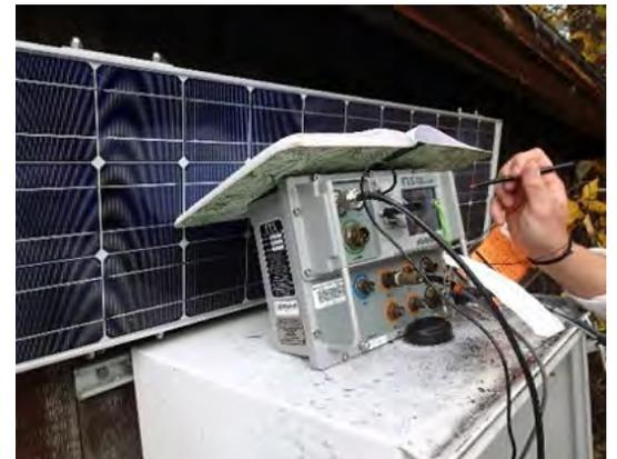
**Image 2 :** Installation d'un enregistreur de température de l'eau en temps réel dans la rivière Stuart.
