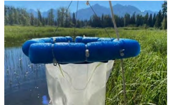
**Image 1 :** Filet à plancton pour l'échantillonnage d'invertébrés dans des zones humides.
