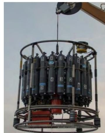
**Image 2 :** Déploiement d'une rosette, un appareil d'échantillonnage en eau profonde.
