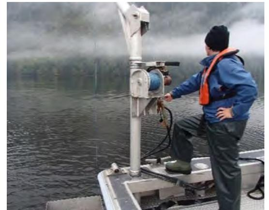
**Image 2 :** Déploiement d'une benne de type Van Veen pour l'échantillonnage benthique.
