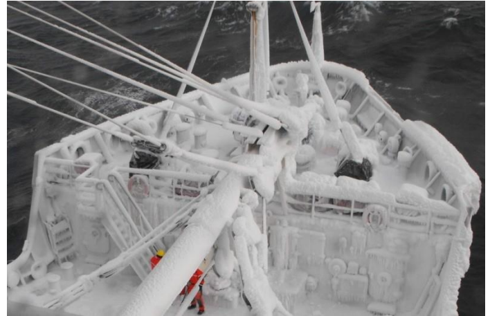
Figure 45 - Accumulation de glace sur le gaillard
