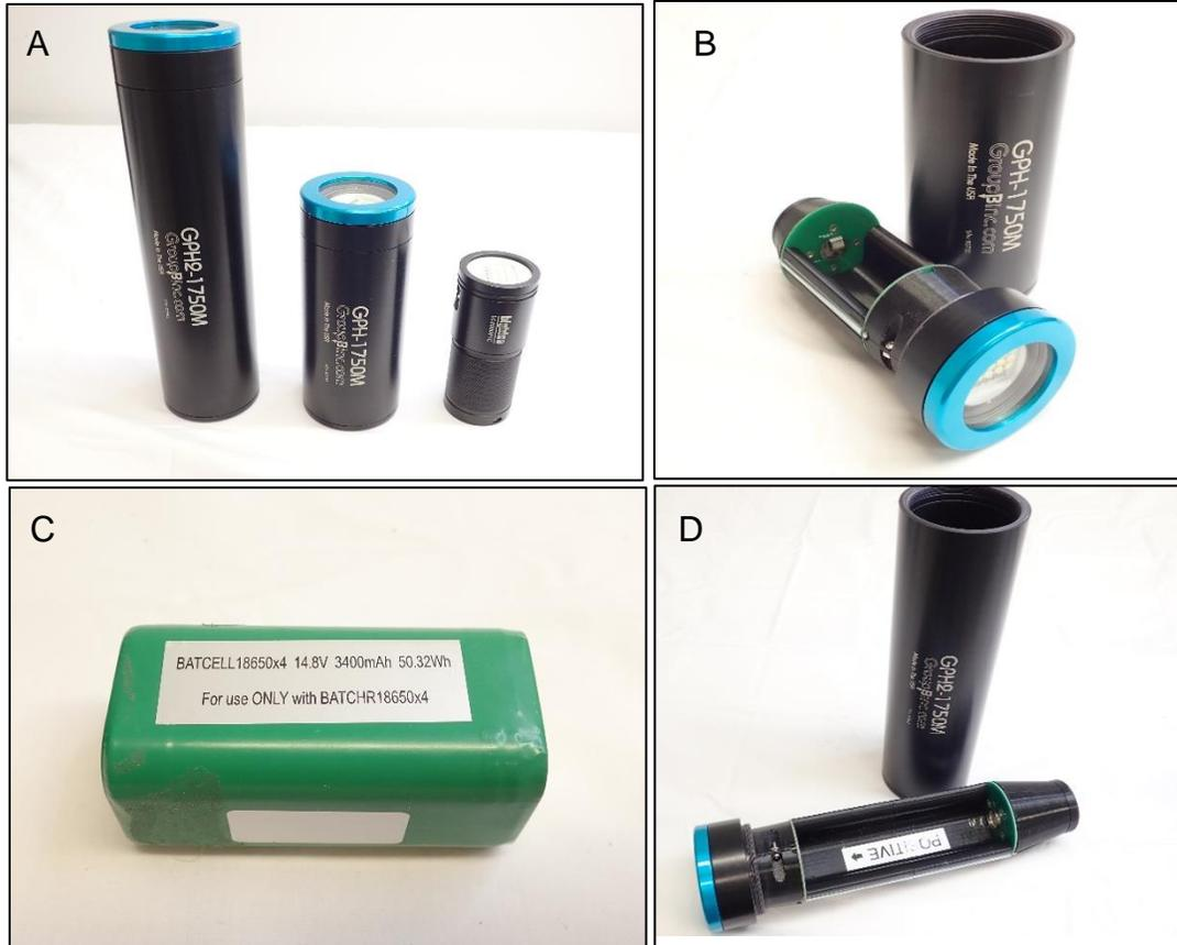
Figure 7. Système d'éclairage du système CVSA comprenant (A) de gauche vers la droite : les lampes modifiées dans les caissons profonds GPH2 (long) et GPH1 (court) et une lampe BigBlue VLC7200 utilisée sur le système côtier; (B) vue intérieure d'une lampe modifiée dans le caisson GPH1; (C) batterie BigBlue utilisée dans tous les modèles de lampes; et (D) vue intérieure d'une lumière modifiée (double batterie) dans le caisson GPH2.
