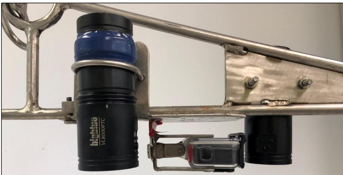
Figure 19. Système d'éclairage composé de deux lampes de plongée fixées de part et d'autre de la caméra du dessus pour éclairer le quadrat.
