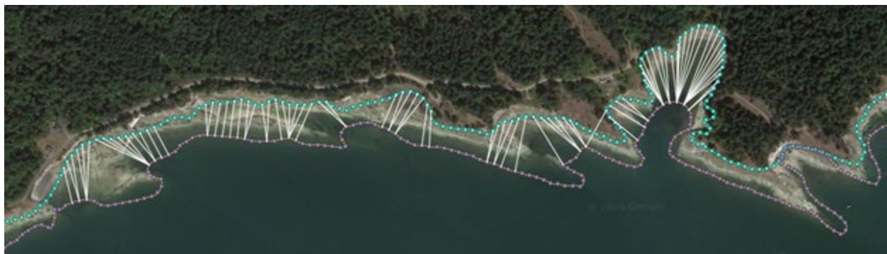
Figure 3. Visualisation d'un échantillon de l'analyse du plus proche voisin pour mesurer les distances entre les laisses de hautes et basses eaux, pour une section du littoral (baie Kuleet près de Ladysmith, C.-B.), avec des lignes représentant des largeurs intertidales égales ou supérieures à 60 m. Les points situés le long des laisses de hautes et basses eaux sont espacés de 40 m.
