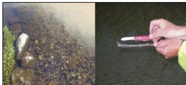
Figure 1.2 Les activités d'aménagement peuvent introduire des sédiments en suspension dans les cours d'eau (image de gauche montrant les sédiments en suspension qui donnent à l'eau une apparence brune) et les sédiments décantés peuvent remplir les fosses et les bancs (image de droite montrant la profondeur du remplissage par les sédiments).
