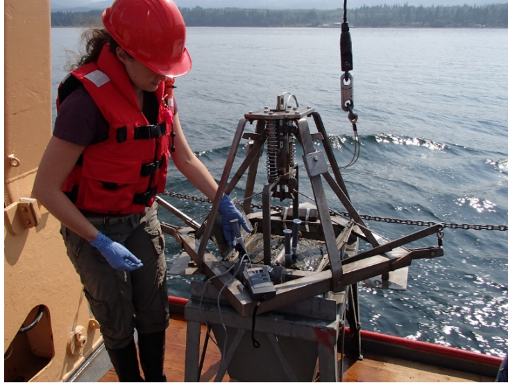
Figure 1 : Benne de type Smith-McIntyre reposant sur une table munie d'une goutte.
