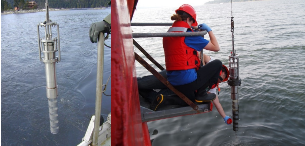
Figure 2 : Carottier par gravité (photo de gauche); récupération d'une carotte de sédiments prélevée au moyen d'un carottier par gravité (photo de droite).
