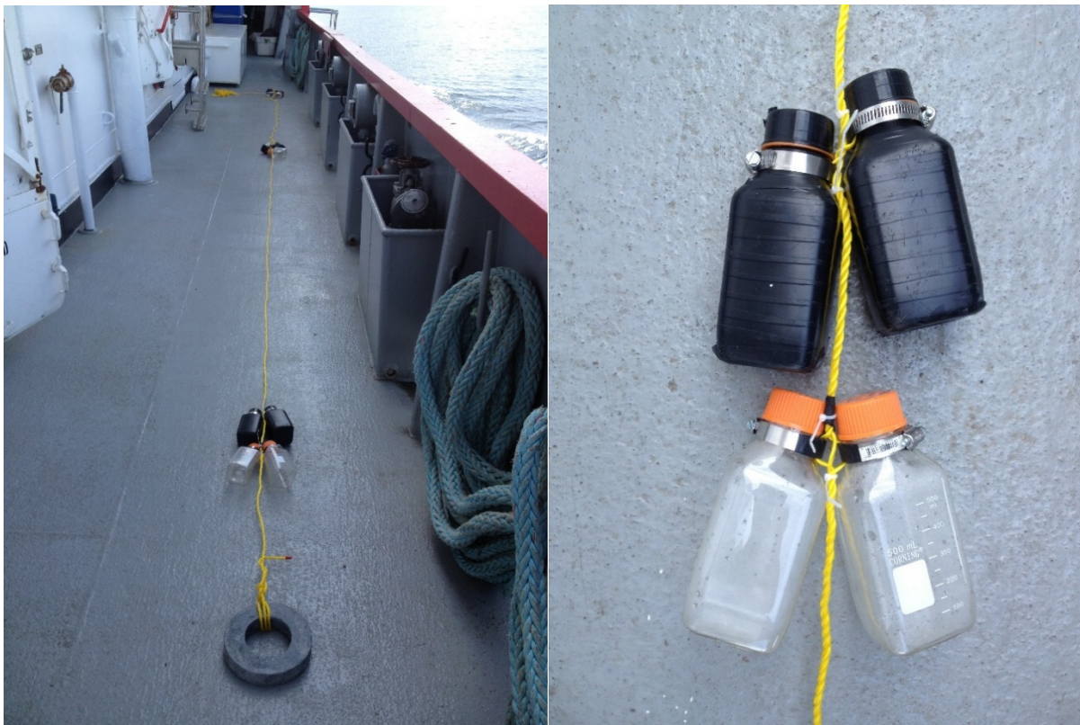
Figure 16 : Amarrage de productivité primaire montrant trois ensembles de bouteilles d'incubation claires et foncées à différentes profondeurs d'eau, situées au-dessus et au-dessous de la couche de chlorophylle maximale (photo de gauche). Vue rapprochée des bouteilles d'incubation attachées à la corde d'amarrage (photo de droite).
