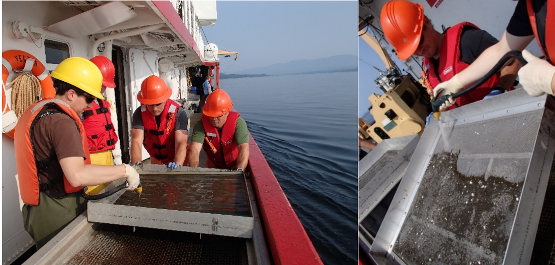
Figure 7 : Tamisage d'un échantillon de macrofaune à l'aide de tamis empilés (un centimètre et 0,5 mm) placés sur une table de tamisage. Sur la photo de droite, le tamis de un centimètre est en arrière-plan, tandis que l'échantillon de macrofaune est prélevé sur le tamis de 0,5 mm.
