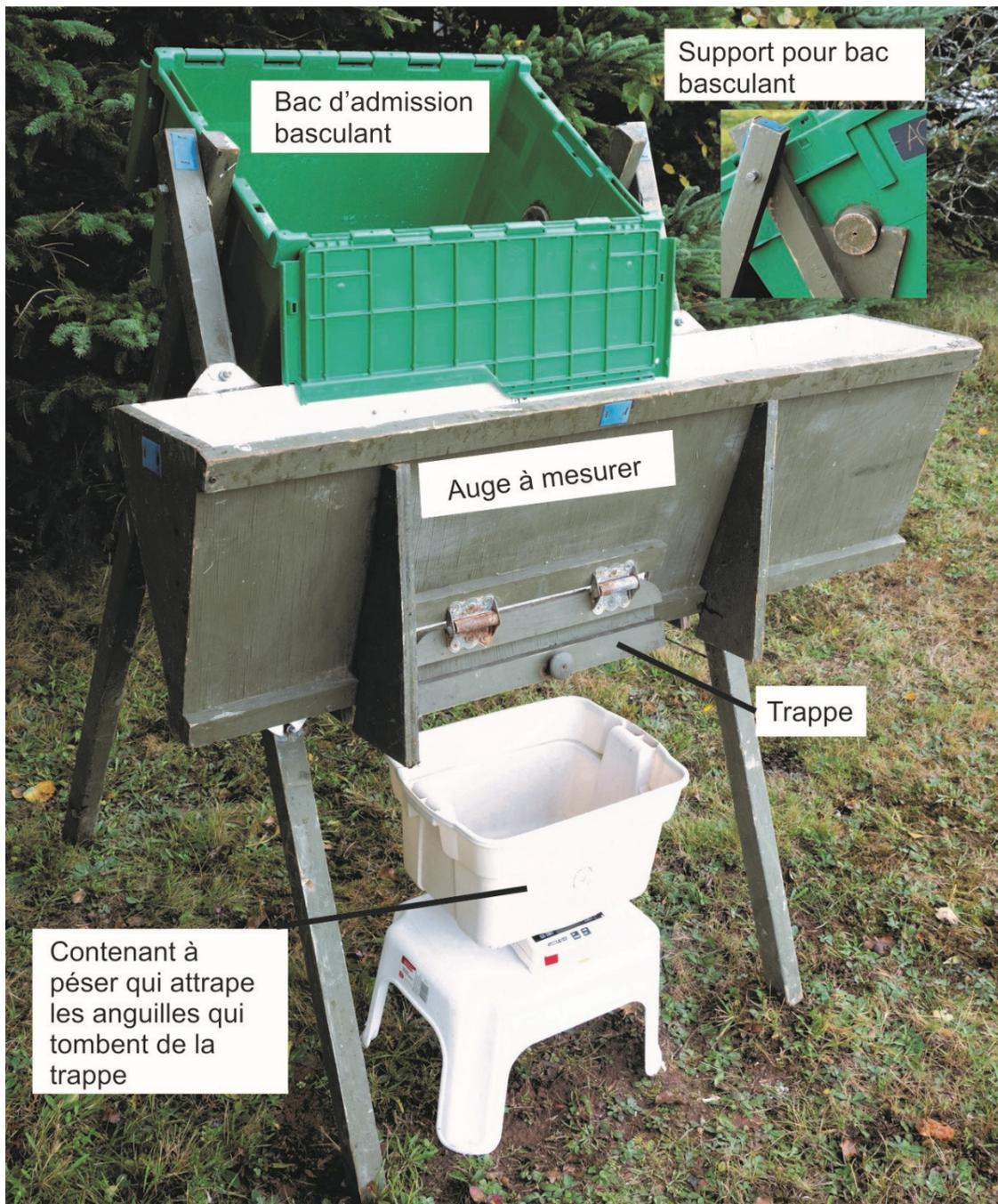
Figure 15. Un système pour mesurer et peser efficacement les anguilles. Une anguille provenant du bac d'admission basculant est versée dans l'auge de mesure, où sa longueur est mesurée par rapport à un mètre à mesurer encastré. Lorsque la trappe à ressort est ouverte, l'anguille tombe dans le bac où elle est pesée. Les pieds sont détachables de l'auge pour le transport et le stockage. L'encart montre comment le bac d'admission est monté sur des supports qui sont fixés aux pieds.
