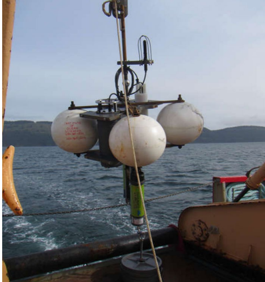
Figure 2 : Un des points d'amarrage de SAP en cours de déploiement. Chaque point d'amarrage est muni de quatre sphères de flottation blanches pour maintenir les amarrages verticaux sur le plancher océanique et d'un double jeu de déclencheurs acoustiques pour la redondance pendant la récupération maintenu par une ancre de 100 kg. L'hydrophone est situé à 2 m au-dessus du plancher océanique.
