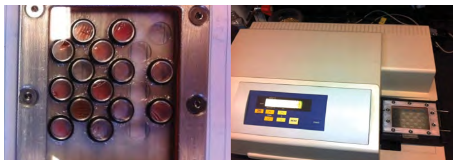
Échantillons de sang contenus dans le tonomètre (à gauche). Le tonomètre est ensuite placé dans le spectrophotomètre (à droite) pour quantifier la courbe d'équilibre de l'oxygène de l'hémoglobine. Photo: Phillip R. Morrison (UBC)
