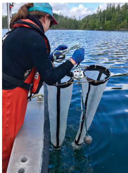
Prélèvement d'échantillons de plancton en vue de l'analyse de l'ADNe à l'aide de filets de type Bongo. Photo : Cathryn Abbott (MPO)
