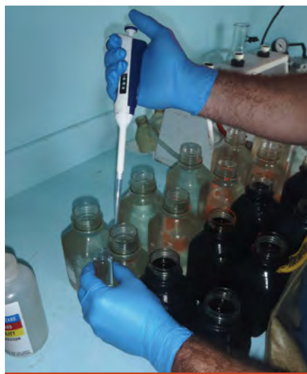
Mesure de la production primaire par l'injection d'un traceur isotopique stable.
