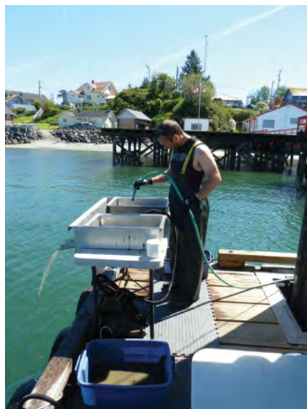
Macrofaune extraite de la boue benthique à l'aide d'eau courante et d'un tamis.
