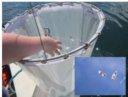
Filet à plancton servant à prélever des échantillons de larves de pou du poisson à l'intérieur et à proximité des cages à saumons. En médaillon : pou du poisson au stade larvaire.
