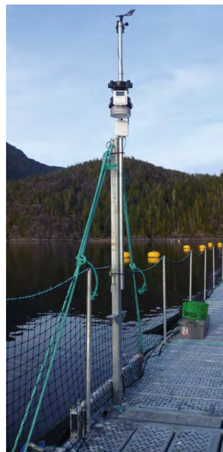
Station météorologique de Davis installée dans une pisciculture de la baie Clayoquot qui fournit des données en temps réel par Internet. Les données sur le vent et le rayonnement solaire sont utilisées comme données d'entrée pour le modèle d'hydrodynamique FVCOM de la côte ouest de l'île de Vancouver. Photo : Glenn Cooper (MPO)
