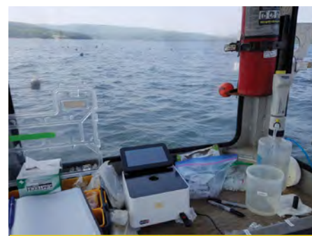
Partie du dispositif utilisé sur le terrain pour mesurer les sulfures libres totaux, montrée ici durant l'échantillonnage à un site conchylicole.
