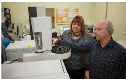
Chis Parrish et Jeanette Wells plaçant un flacon d'échantillon dans l'échantillonneur automatique d'un chromatographe en phase gazeuse afin de déterminer la composition en acides gras d'extraits lipidiques.
