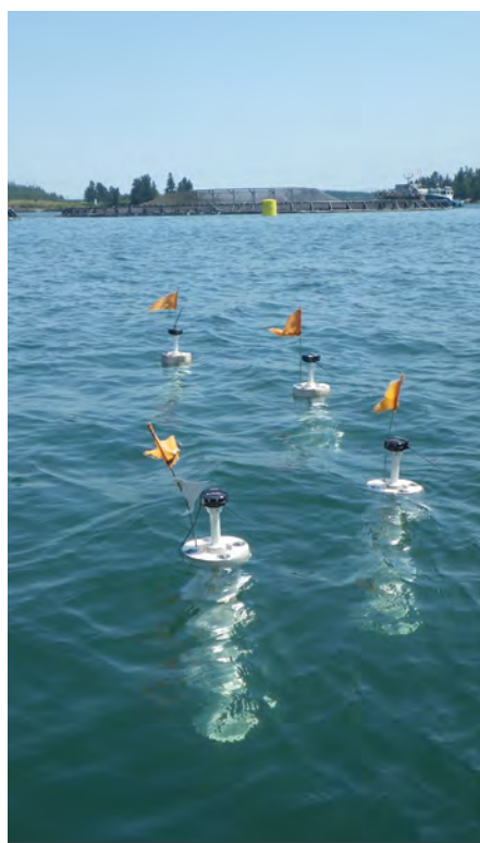
Dériveurs de surface suivis par GPS Photo : Sarah Scouten (MPO)
