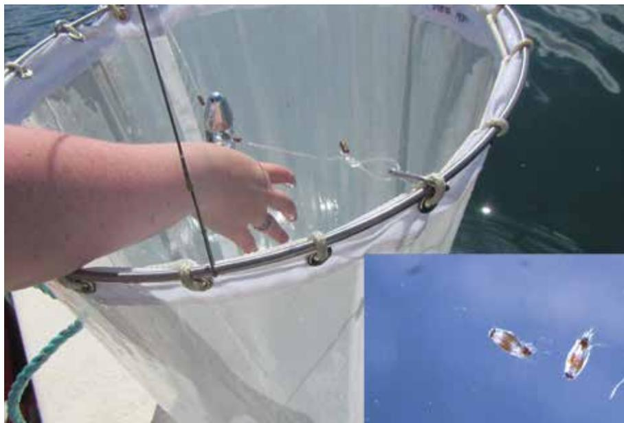
Filet à plancton avec débitmètre utilisé pour échantillonner les larves du pou du poisson (encadré) à l'intérieur et autour des exploitations salmonicoles de la baie de Fundy. Photo : Shawn Robinson (MPO)
