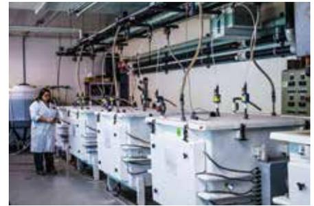
Technicienne du CNRC, Jenny MacPherson, pose avec les photobioréacteurs « Brite-Box » développés par le CNRC (capacité de production > 10 000 L). Photo : Scott MacQuarrie (CNRC)
