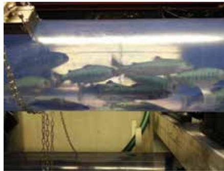
Un plan plus rapproché d'un saumon de l'Atlantique (*Salmo salar*) en mouvement dans le tunnel de nage de type Brett à deux couloirs. Photo : Yangfan Zhang (UBC)
