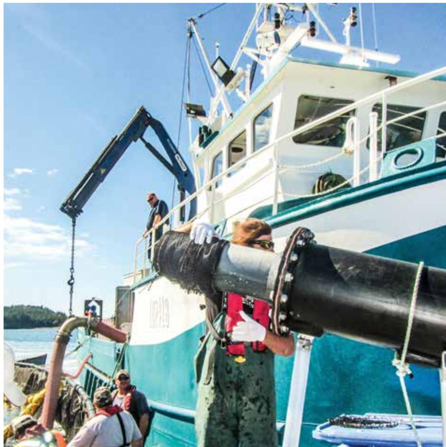
Mise à l'essai de l'efficacité du modèle de laboratoire de la douche à l'eau tiède sur le terrain, dans la baie de Fundy, avec des partenaires de l'industrie. Photo : Shawn Robinson (MPO)
