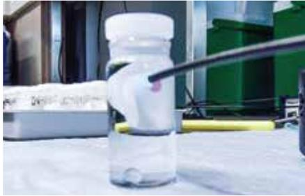
Chambre de respiration miniature comportant un filtre (0,2 µm) recouvert de bactéries et de seston provenant d'un échantillon. Le point rose est un optode d'oxygène permettant de lire les concentrations en oxygène au fil du temps à l'intérieur du flacon lorsqu'on le soumet à une pulsation de lumière bleue depuis l'extérieur du flacon à l'aide d'une sonde noire en fibre optique. Photo : Shawn Robinson (MPO)
