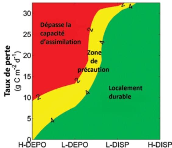
La simulation du processus benthique permet d'estimer la capacité d'assimilation des sédiments près des sites aquacoles. L'oxygène dans les sédiments est profilé en tant que fonction des dépôts de déchets (aliments et granulés pour poisson) par rapport au régime hydrodynamique, de hautement sédimentaire à hautement dispersif. Les régions en rouge représentent des sédiments peu oxygénés en raison d'un taux de dépôt élevé et d'une faible dispersion.
