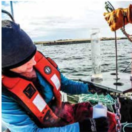
Collecte par trappe à sédiments aux fins d'analyses portant sur les particules en suspension. Photo : Kristy Hugill (MPO)
