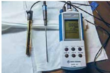
Sonde à sulfures, sonde à température et compteur (de gauche à droite). Photo : Fred Page (MPO)
