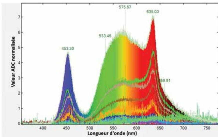
Spectre produit par les diodes électroluminescentes (DEL).
