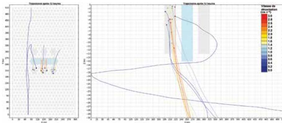
Vue en plan et trajectoires du profil vertical après douze heures d'un sous-ensemble de particules affichant différentes vitesses de décantation relâchées de façon aléatoire dans trois cages à poissons (gris pâle). Les palangres à moules sont représentées en bleu pâle. Il convient de noter que les échelles verticale et horizontale dans les profils verticaux sont différentes à des fins de visualisation.
