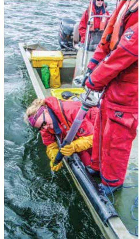
Collecte de carottes aux fins d'analyses portant sur les invertébrés benthiques et la composition chimique des sédiments. Photo : Megan Otu (MPO)
