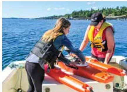
Taryn Minch (UNBSJ) et Adena Peters (UNBSJ) surveillant un profil de courant à l'aide d'un sondeur Doppler lors de la mesure de la vitesse et de la direction du courant aux alentours d'une ferme aquacole de la baie de Fundy. Photo : Shawn Robinson (MPO)
