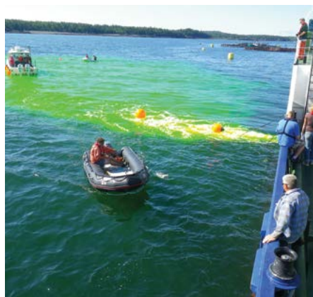
Colorant rejeté à un site aquacole du Nouveau-Brunswick dans le cadre d'un essai sur le terrain visant à étudier le transport et la dispersion des agents thérapeutiques chimiques utilisés pour lutter contre le pou du poisson. Photo : Fred Page (MPO)
