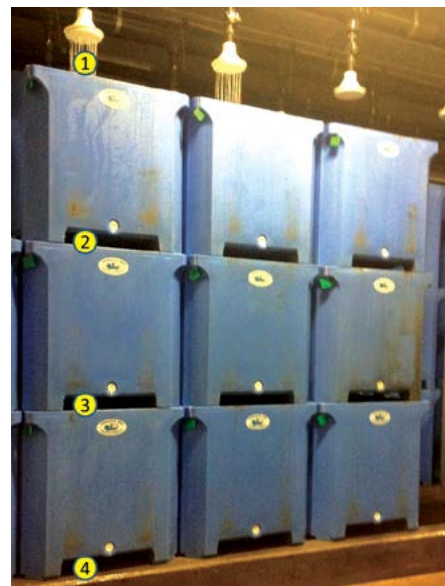
Réservoirs de stockage de moules vivantes empilés. De l'eau est introduite au sommet, puis percole jusqu'au bas du réservoir. Les emplacements d'échantillonnage de l'eau sont indiqués par les cercles jaunes numérotés. Photo : Daniel Bourque (MPO)
