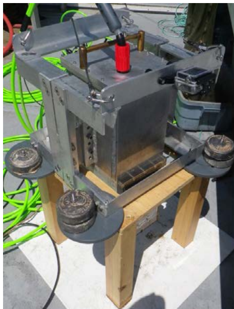
Appareil d'imagerie de profils sédimentaires et image de sédiments côtiers utilisé dans l'évaluation de la santé benthique. Photo : Michelle Simone
