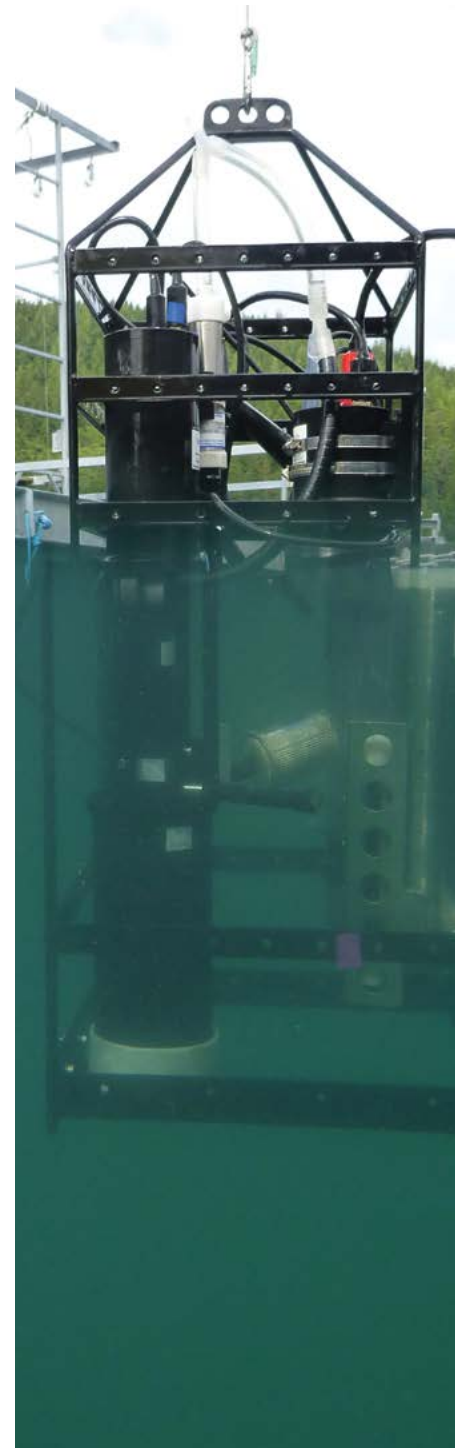
Le profilier bio-optique que l'on abaisse dans une cage de morues charbonnières. Photo : Justin Del Bel Belluz (UVic)
