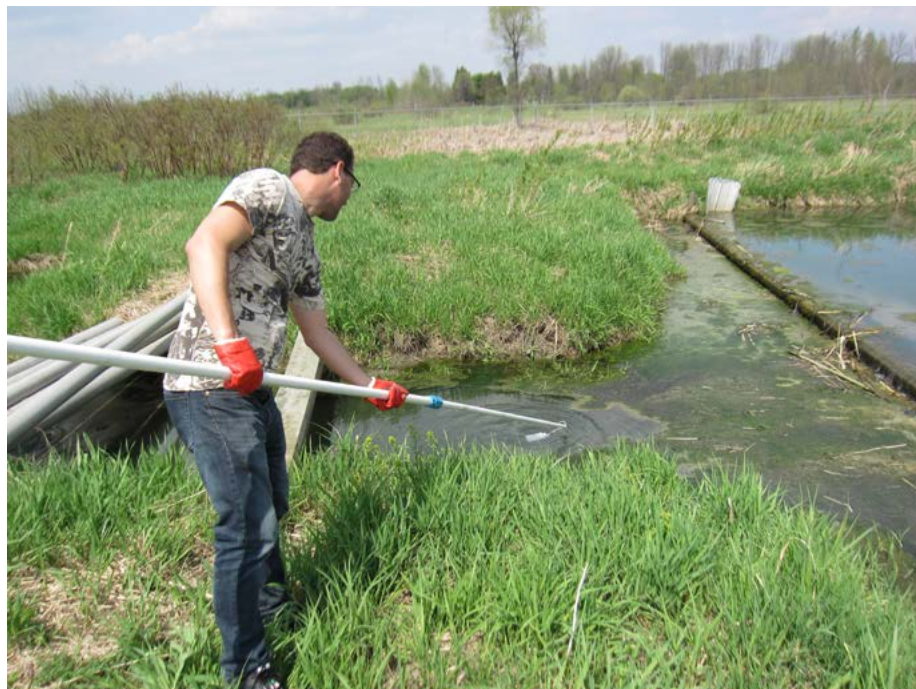
Échantillonnage des étangs d'eaux usées pour établir un budget de phosphore. Photo : Nick Jewitt (Queen's U)
