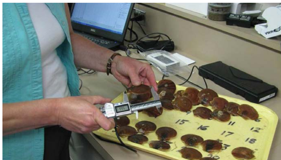
Mesure des pétoncles au moyen d'un pied à coulisse électronique, qui enregistre directement les données dans un fichier Excel. Photo : Leslie-Anne Davidson (MPO)
