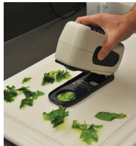
La couleur de fragments de l'algue verte, Ulva lactuca , est analysée à l'aide d'un spectromètre de couleur portatif afin de quantifier les nutriments dissous. Photo : Andrew Cooper (MPO)
