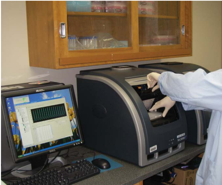
Un appareil de réaction en chaîne de la polymérase quantitative (PCR) qui amorcera la réaction permettant de détecter le matériel génétique de la septicémie hémorragique virale. Photo : MPO
