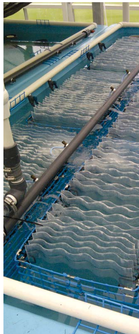
Les plaques en fibre de verre qui seront utilisées pour la fixation des larves d'oursins dès qu'elles seront produites dans l'écloserie et prêtes pour la métamorphose. Photo : Shawn Robinson (MPO)
