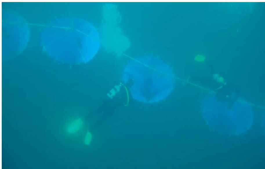
Plongeurs travaillant sur de grands pièges à sédiments afin de mesurer la production de biodépôts par les moules d'élevage dans les Îles de la Madeleine. Photo : François Roy (MPO)
