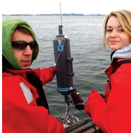
Craig Smith (MPO; à gauche) aide Hannah Bradford (UNBSJ; à droite) à recueillir des échantillons d'eau de mer pour mesurer la densité bactérienne de la colonne d'eau aux environs d'un site salmonicole. Photo : Shawn Robinson (MPO)
