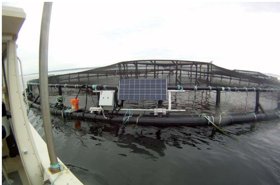
Piège lumineux pour le pou du poisson fonctionnant à l'énergie solaire et attaché à une cage à saumon dans la baie de Fundy. Photo : Nathaniel Feindel (MPO)
