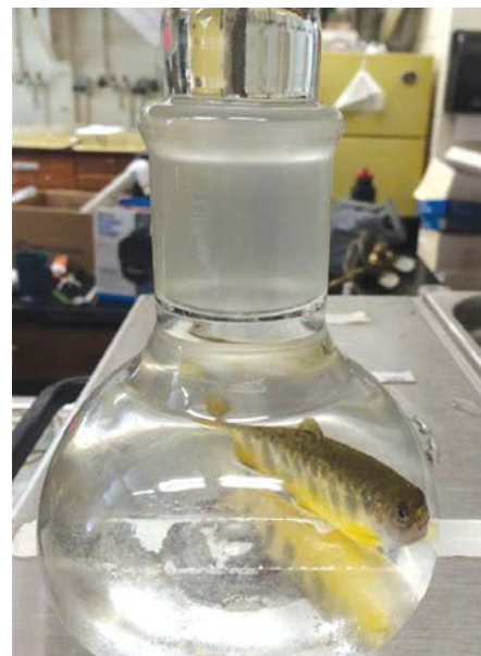
Omble de fontaine juvénile dans un respiromètre servant à mesurer la consommation d'oxygène. Photo : Kathleen O'Donnell (UNB)
