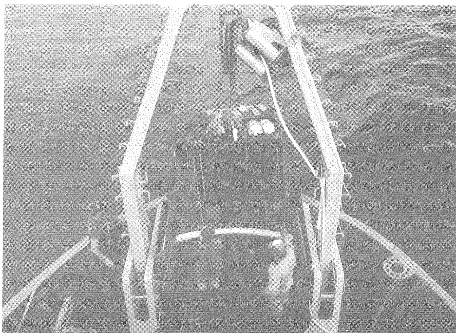
Fig. 1 L'échantillonneur BIONESS à dix filets-collecteurs. Les filets sont descendus sur ordre de la surface, ce qui permet d'échantillonner le zooplancton à une profondeur déterminée.
