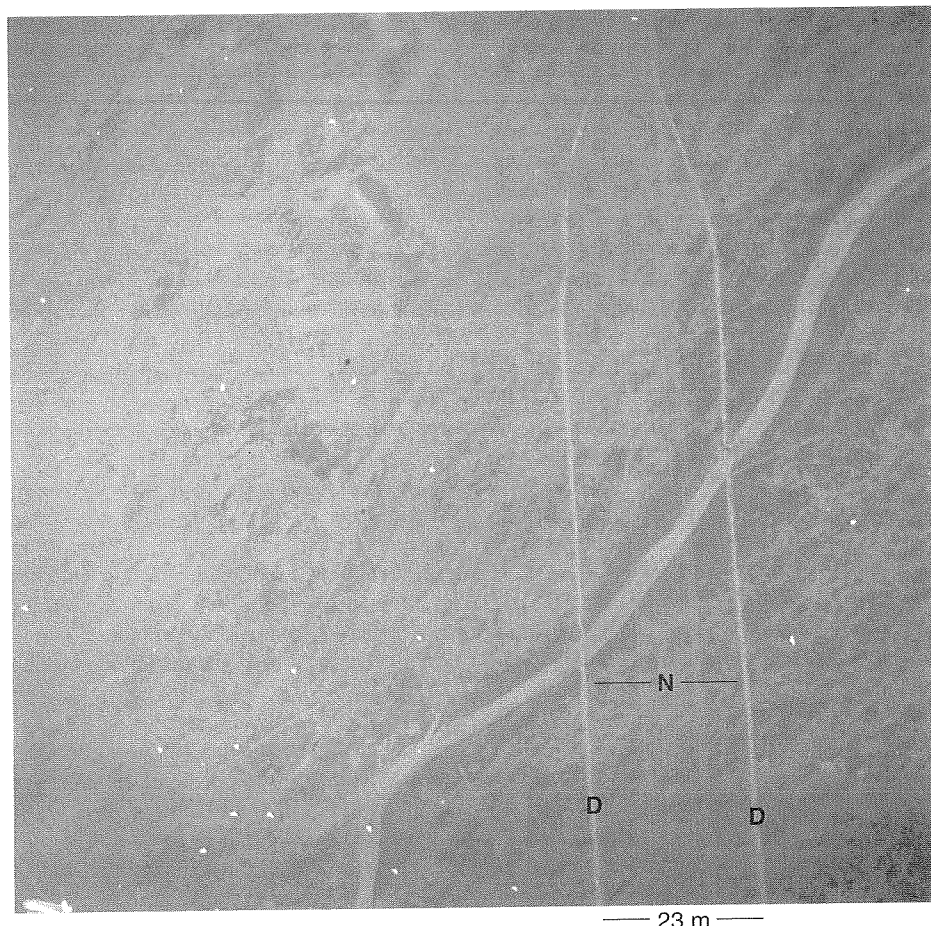
Figure 4. Traces laissées dans une zone intertidale au large de la plage Dehaven par un chalut à flets de 18 m (N) et par les panneaux de ce chalut (D). Photo prise à une altitude d'environ 150 m.
