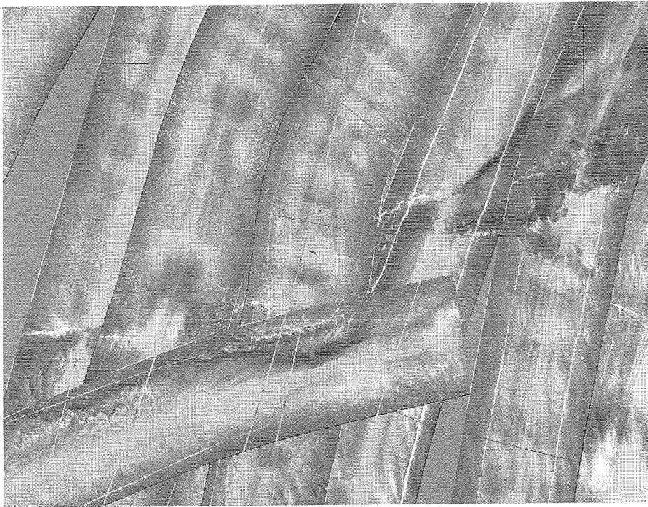
Figure 4. Mosaïque de données obtenues par sonar à balayage latéral à partir de lignes adjacentes. Notez qu'il est possible de suivre le chenal dans l'ensemble de la mosaïque.
