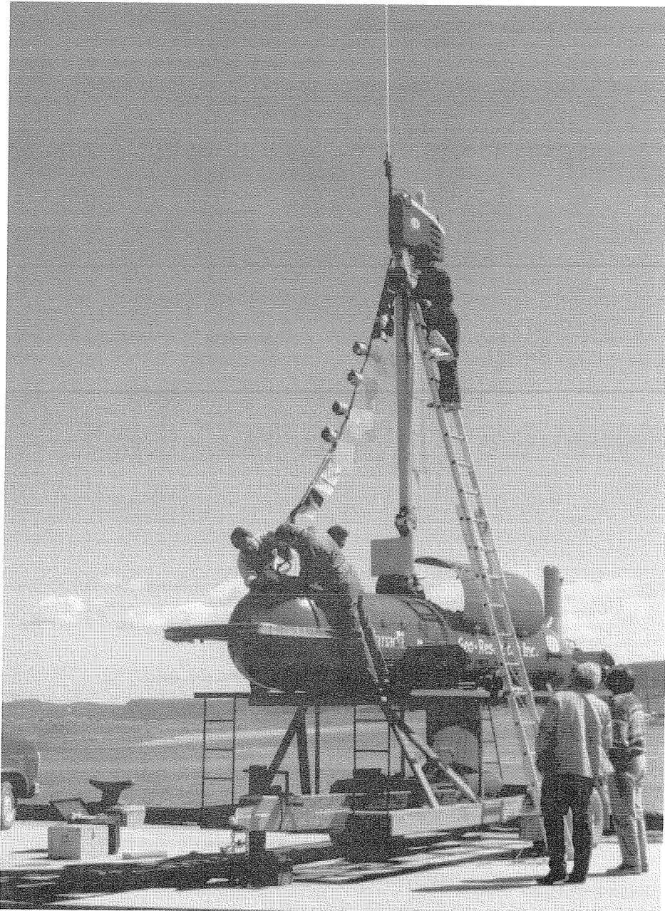
Figure 9. Pour les besoins d'une étude du déferlement des vagues, on a installé un sonar à balayage latéral sur la quille du DOLPHIN, des thermistances et des capteurs de fraction de vide le long de son étai avant, des sonars orientés vers le haut et vers le bas sur son étrave, ainsi que des caméras vidéo au sommet et à la base de son mât. Tous ces appareils ont bien fonctionné et ont permis au DOLPHIN d'enregistrer des données.
