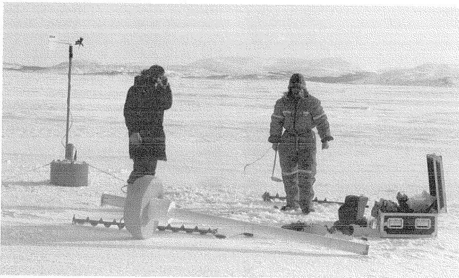
Figure 2. Installation de la plate-forme de surveillance des glaces sur les glaces extracôtières du Labrador, et d'une balise de signalisation des glaces, équipée d'un anémomètre, à l'arrière-plan.
