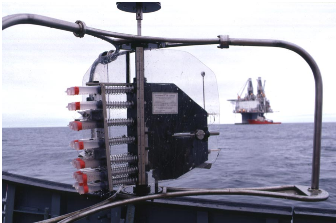
Figure 3 : Récupération du BOSS après échantillonnage près de la plate-forme Hibernia sur les bancs de Terre-Neuve. Les échantillons de sédiments en suspension sont prélevés dans la couche limite benthique à l'aide de seringues activées par un ressort à 7 profondeurs, entre 5 et 50 cm au-dessus du fond marin.
