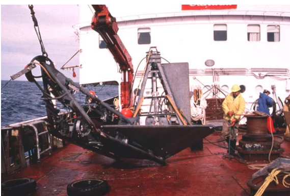
Figure 3 : Drague épibenthique utilisée pour récolter les gros organismes vivant sur le fond marin (échantillonne environ 18 m 2 par trait de 50 m).
