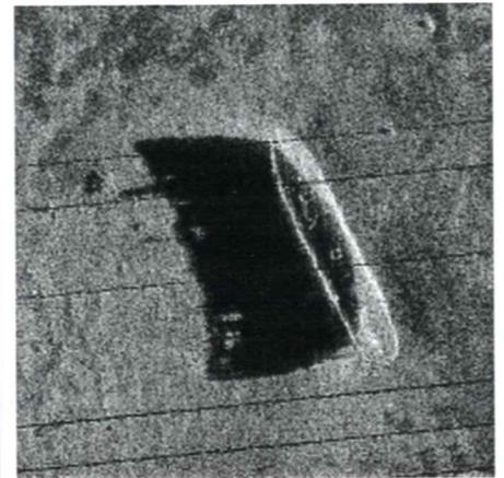
Image d'une épave à haute résolution obtenue par balayage latéral multifaisceaux.
