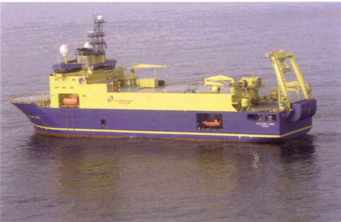
Mouilleur de câbles sous-marins (MPO).
