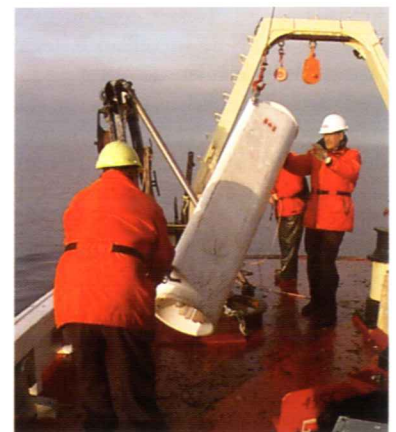
Récupération d'un collecteur de sédiments dans le lac Bras d'Or. Le collecteur a été mouillé en position verticale sous la surface de l'eau pendant environ six mois. Les petites bouteilles visibles au bas du collecteur contiennent des échantillons des particules précipitées dans l'eau, qui est recueillie à des intervalles prédéterminés.
