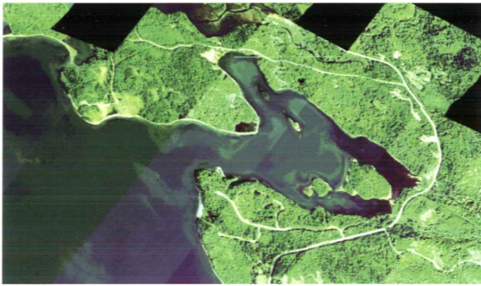
Image, obtenue par imageur spectrographique compact aéroporté (CASI), d'une petite partie du lac Bras d'Or montrant le tracé des limites des caractéristiques sous-marines à des profondeurs de 5-10 m. Ces caractéristiques seront associées à des types d'habitat benthique après vérification in situ et comparaison avec les données du sonar multifaisceaux.
