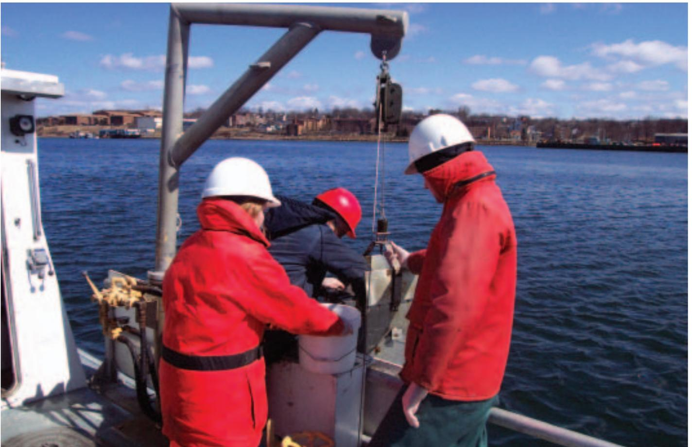
Des étudiants tiennent la benne Eckman Grab (benne servant à prélever des sédiments de fond) et un seau tandis que Jim Leonard, du GCO, retire de la benne des sédiments prélevés dans le port d'Halifax pour les verser dans un flacon placé dans le seau.
