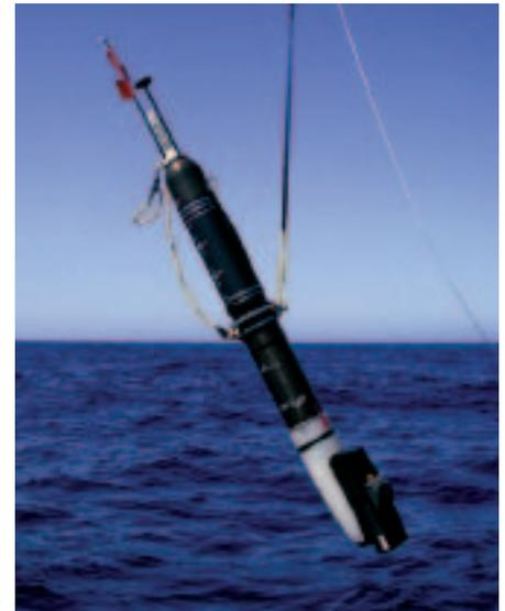
Figure 7. Prototype du SOLOPC utilisé par CalCOFI dans les eaux régionales en septembre 2005 – l'appareil se compose d'un COPL auquel on a intégré un flotteur dérivant SOLO.
