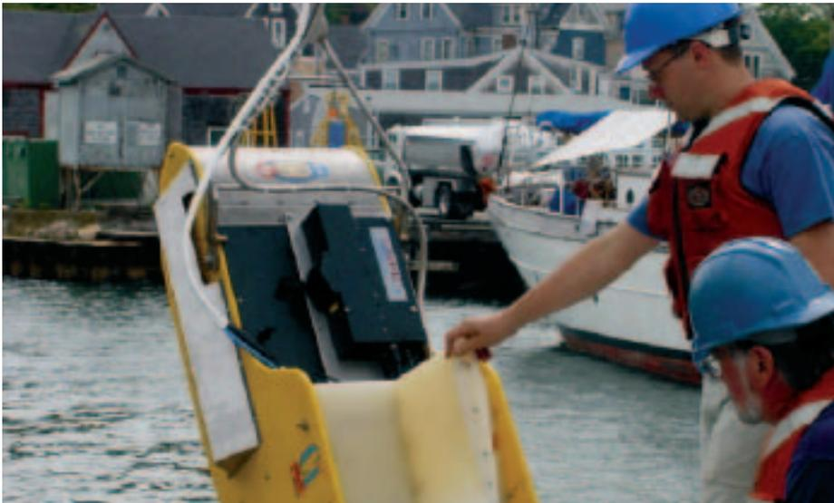
Figure 6. Le COPL installé sur un véhicule remorqué prêt à effectuer un relevé dans la rivière Hudson
