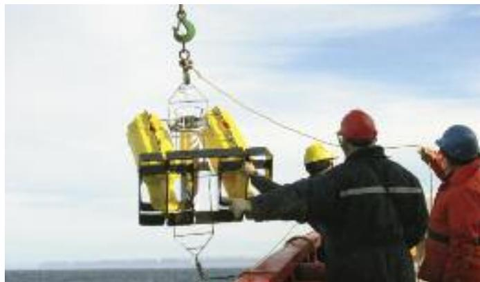
Déploiement d'un sonar à vision vers le haut pour la surveillance du tirant d'eau des glaces
