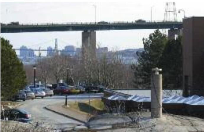
**Figure 3.** Le pilier portant l'antenne GPS est fixé dans l'assise rocheuse située au-dessus de l'entrée principale de l'IOB et donnant sur le port d'Halifax. Cette station active de mesure exploitée par la Division des levés géodésiques de RNCan effectuée continuellement des enregistrements de position toute seconde depuis 2002. Des solutions hebdomadaires calculées servent à estimer le mouvement horizontal et vertical de la croûte terrestre.
