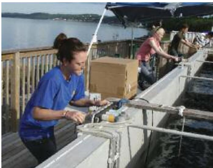
**Figure 4.** Des étudiants embauchés pour l'été et des membres du personnel du CRPGESE récupèrent des échantillons d'une série chronologique à diverses profondeurs de la cuve à houle pour déterminer l'efficacité d'un dispersant chimique.
