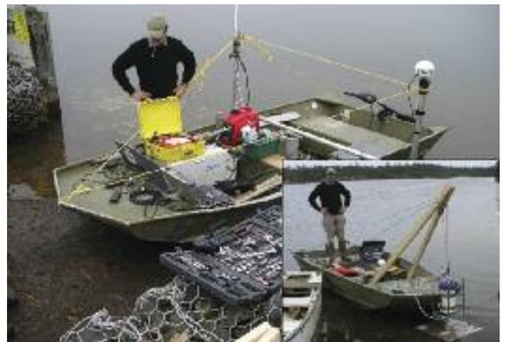
**Figure 2.** Tim Milligan à bord de l'embarcation de recherche utilisée pendant l'étude de la ZPM de Basin Head, à l'Î.-P.-É. La photographie principale montre l'embarcation conçue pour effectuer des levés bathymétriques et des échantillonnages de la qualité de l'eau. La photographie intercalée montre l'embarcation conçue pour effectuer des ancrages. On peut remarquer le petit hors-bord électrique.
