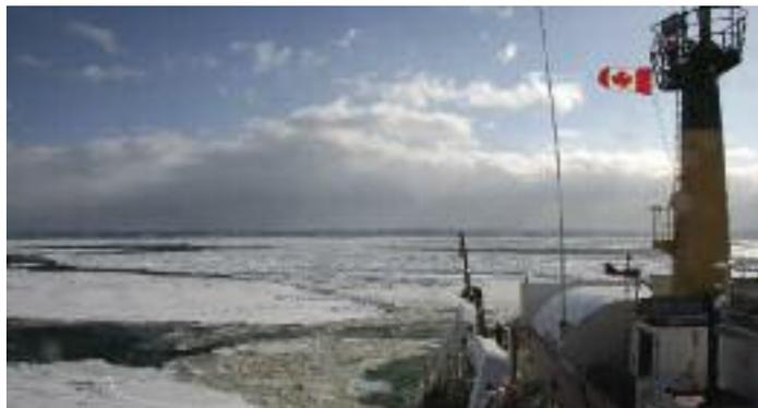
**Figure 2.** Essai sur le terrain mené de concert par le CRPGESE et par la Garde côtière canadienne pour lutter contre les déversements d'hydrocarbure sur la banquise grâce à l'application de particules minérales et au mélange de ces dernières par le souffle des hélices du garde-côte du NGCC *Martha L. Black*
