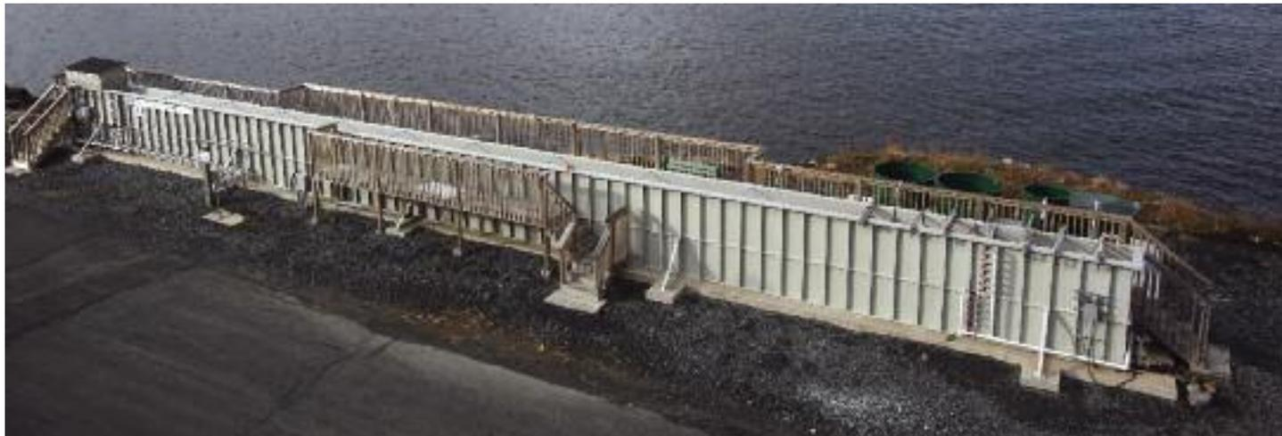
**Figure 1.** La cuve à houle de l'IOB est dotée d'un générateur de vagues commandé par ordinateur, qui produit des vagues progressives régulières et des déferlantes. Elle a été munie par la suite d'un système continu pour simuler le mouvement de gouttelettes d'hydrocarbure dû à la coexistence des vagues et des courants et pour permettre d'étudier les effets de la dilution sur la toxicité des hydrocarbures dispersés par des moyens physiques et chimiques sur les espèces pélagiques et benthiques.
