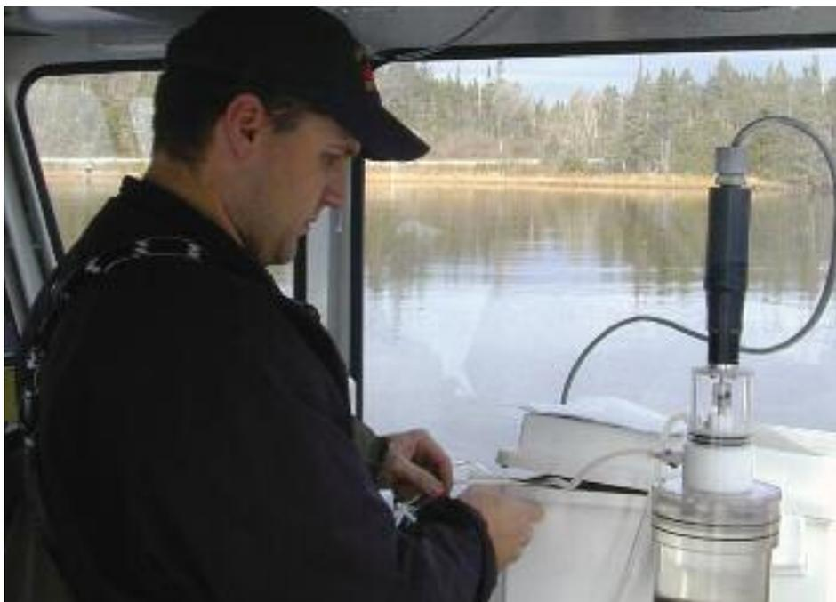
**Figure 3.** Brent Law de la DRE, qui utilise la chambre de reproduction de l'érosion pour éroder de manière sélective de la neige marine reposant sur la surface intacte d'une carotte récemment prélevée au moyen de la petite carotteuse lente
