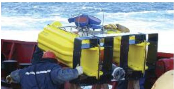
Déploiement d'un profileur de courant acoustique Doppler pour la surveillance de la dérive des glaces et des courants océaniques
