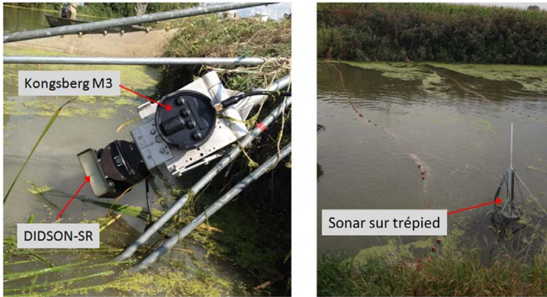
Figure 4. Sonar DIDSON et sonar Kongsberg montés sur un trépied réglable (image de gauche). Sonar sur trépied déployé dans l'enceinte du filet d'isolement (image de droite). Source : Milne Technologies.
