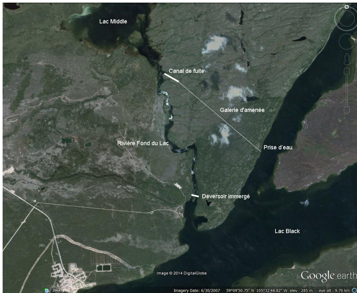
Figure 1. Carte de la rivière Fond du Lac, entre les lacs Middle et Black (tiré de Google Earth) Les emplacements approximatifs du déversoir immergé, de l'ouvrage de prise d'eau, de la galerie d'amenée et du canal de fuite aménagés dans le cadre du projet hydroélectrique Tazi Twé sont indiqués.
