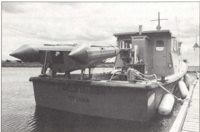
Entre autres équipements, le J. WILLIE-DERASPE est doté d'un bateau Avon de 13 pieds et d'un treuil pouvant soulever tout genre d'engin de pêche utilisé aux Îles.
