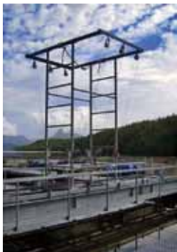
Le système d'exploitation des mollusques SEATram et les treuils créés pour le site d'AMTI de Kyuquot SEAfoods Ltd. Crédit : Eric Hoevenaars (UVic)
