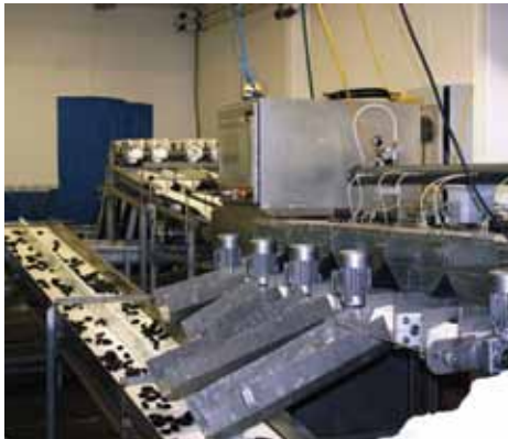
Trieuse par imagerie pour la moule bleue. Crédit : Confédération Cove Moules Co. Ltd
