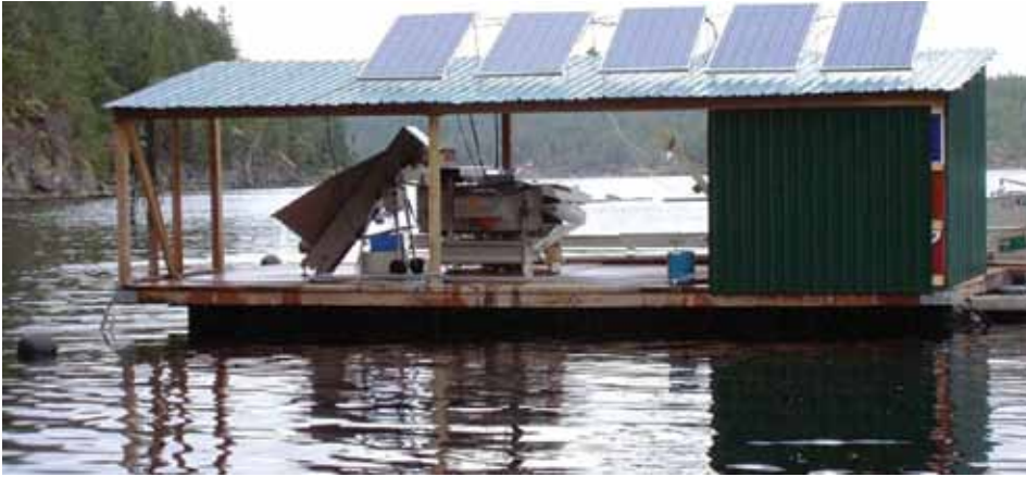
Système mobile flottant de tri et de manipulation des naissains. Crédit : Yves Perreault (Little Wing Oysters Ltd.)
