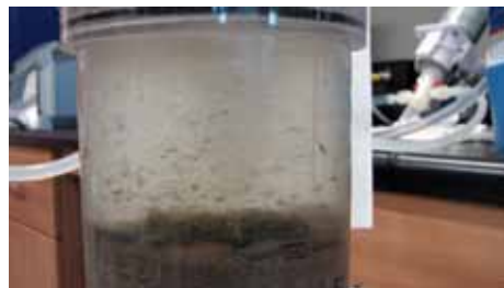
Mesure de l'érosion, en laboratoire, de déchets produits par une culture de moules. La contrainte de cisaillement appliquée de 0,08 Pa est suffisante pour mobiliser les déchets et remettre en suspension les plus gros agrégats. Crédit : Particle Dynamics Lab, Institut océanographique de Bedford (MPO)
