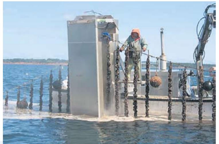
En haut : Le système de traitement à la chaux utilisé dans le traitement de l'ascidie plissée dans la baie de Malpèque recouvre la chaux dans la partie horizontale du mécanisme pour une réutilisation. Ce système appartient à Martin MacDonald.
