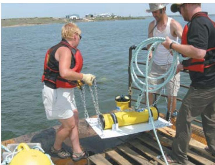
Installation d'un courantomètre dans le lac Diefenbaker, en Saskatchewan. (Photo : H. Zanzerl)
