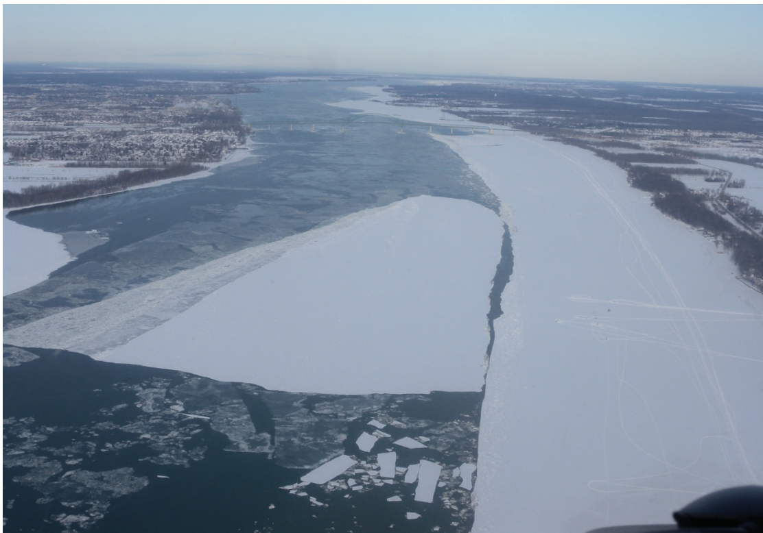
Figure 29 : La voie navigable peut facilement être bloquée si la glace de batture est détachée
