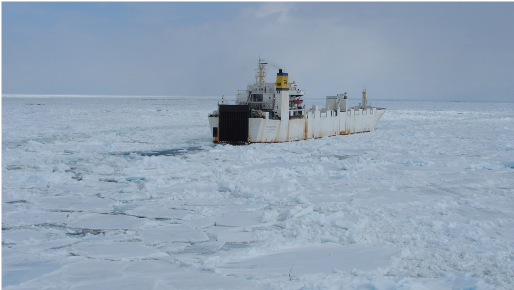
Figure 53 De la glace sous pression va fermer le passage derrière le navire
