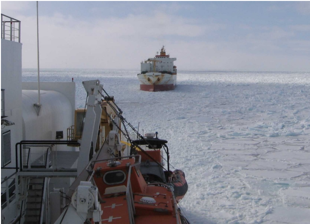
Figure 47 : Le Commandant du brise-glace déterminera la distance sécuritaire pour l'escorte
