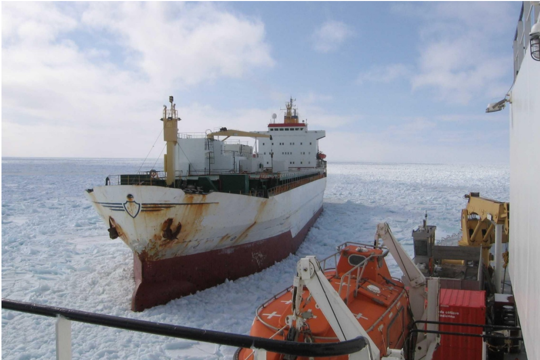
Figure 48 : Un brise-glace en renfort le long d'un navire pour le libérer des glaces
