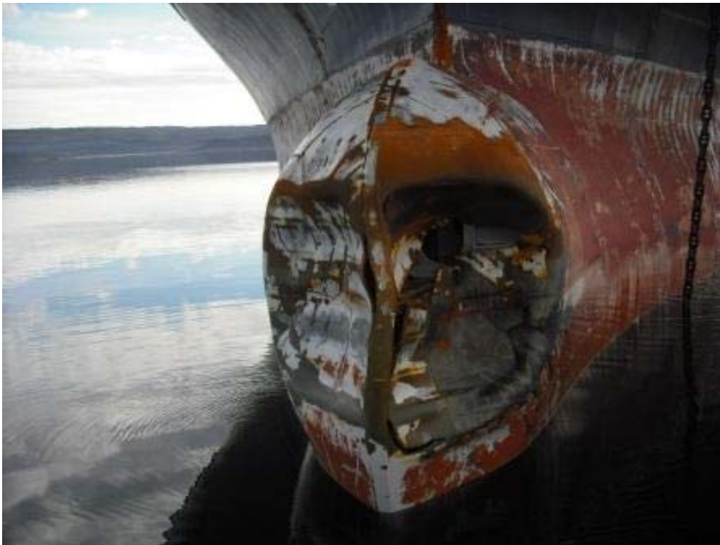
Figure 43 : Étrave à bulbe d'un navire de charge classé 100 A1 cote glace 1A de Lloyd's, endommagée par les glaces alors qu'il se dirigeait vers Iqaluit (Nunavut) en juillet.
