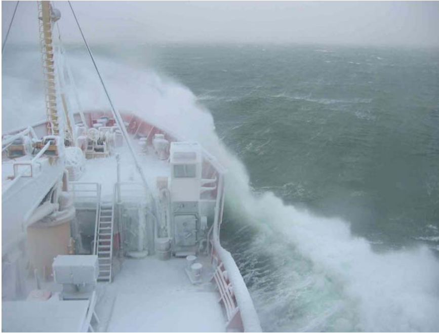
Figure 44 : Conditions de fort givrage
