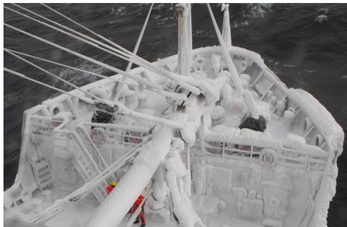
Figure 46 Accumulation de glace sur le gaillard
