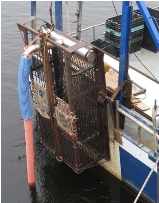
Figure 2. Drague hydraulique de type Nouvelle-Angleterre.
