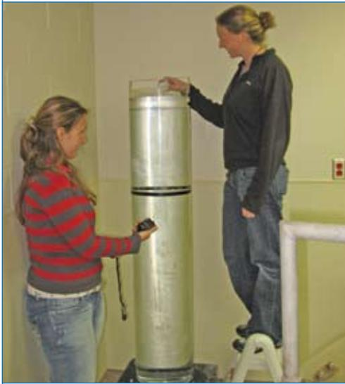
**Figure 1.** Calcul du taux de décantation à l'aide d'une colonne de sédimentation
