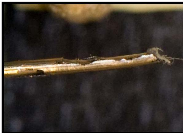
Figure 8. Photographie d'une tige de nickel corrodée après 18 semaines dans l'eau de mer.
