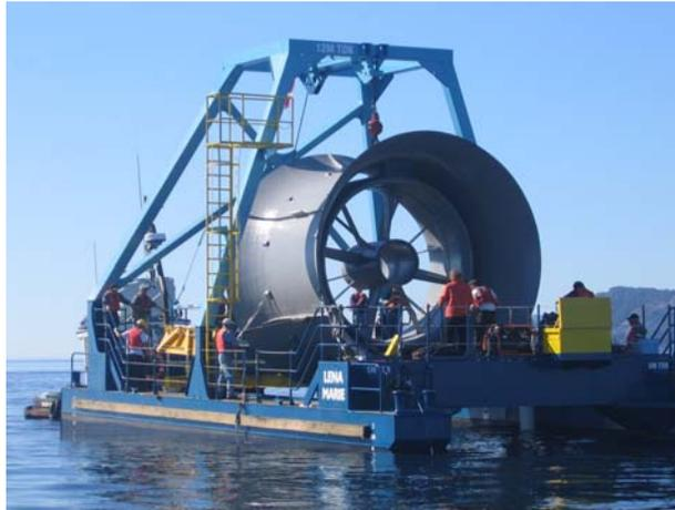
Figure 1. Exemple d'un dispositif de transformation d'énergie marémotrice (Race Rocks, C.-B.).
