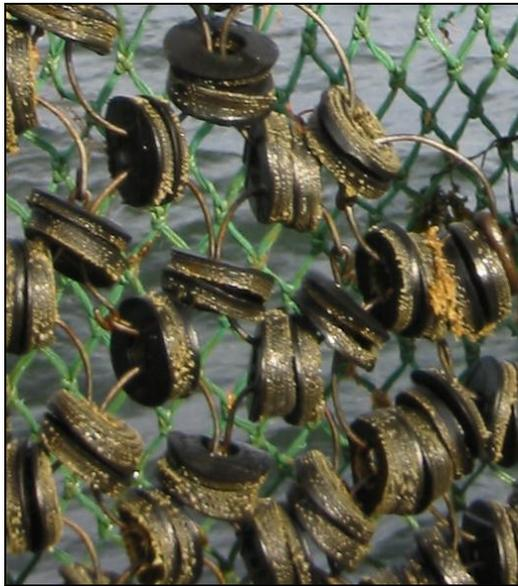
**Figure 6. Anneaux de métal de 7,6 cm (3 pouces) de diamètre et rondelles de caoutchouc composant la partie inférieure du panier.**
