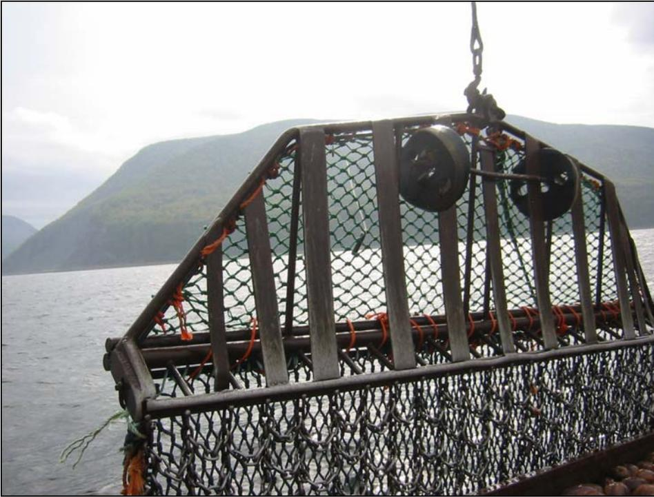
**Figure 5. Haut de la drague (gueule) de type LGS (light green sweep urchin drag) utilisée lors de la mission d'échantillonnage.**
