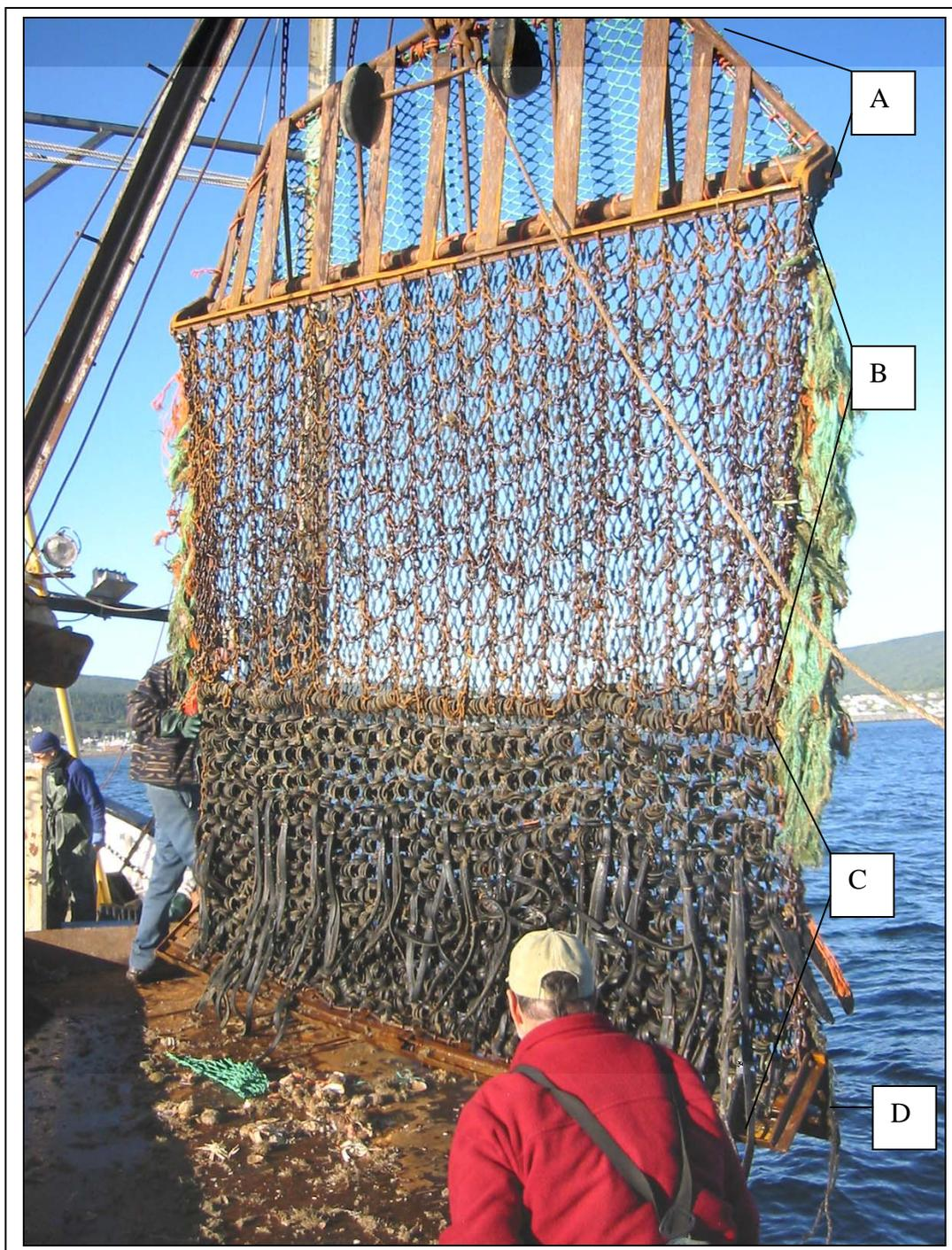
**Figure 4. Drague de type LGS (light green sweep urchin drag) utilisée lors de la mission d'échantillonnage du concombre de mer sur la rive nord de la péninsule gaspésienne à l'automne 2004. La drague est composée de quatre parties : A : la gueule, B : la matrice de chaînes, C : le panier d'anneaux de métal et D : le fermoir.**
