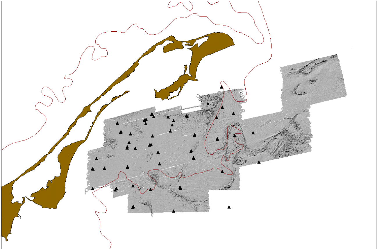
Figure 5. Position des stations d'échantillonnage au chalut sur une image du fond obtenue par sondage avec le sondeur multifaisceaux Simrad EM-1000.
