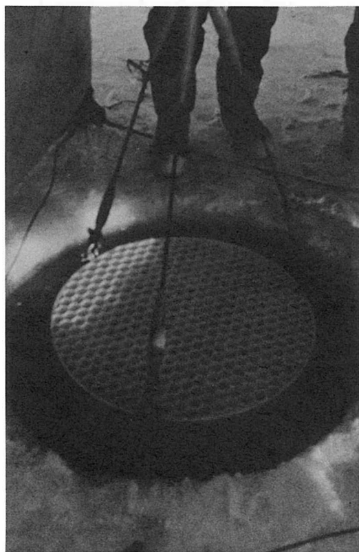
Piège séquentiel abaissé dans un trou de 1,1 m de diamètre creusé dans une couche de glace de 2 m d'épaisseur au large du cap Bathurst avant la débâcle de 1987.
