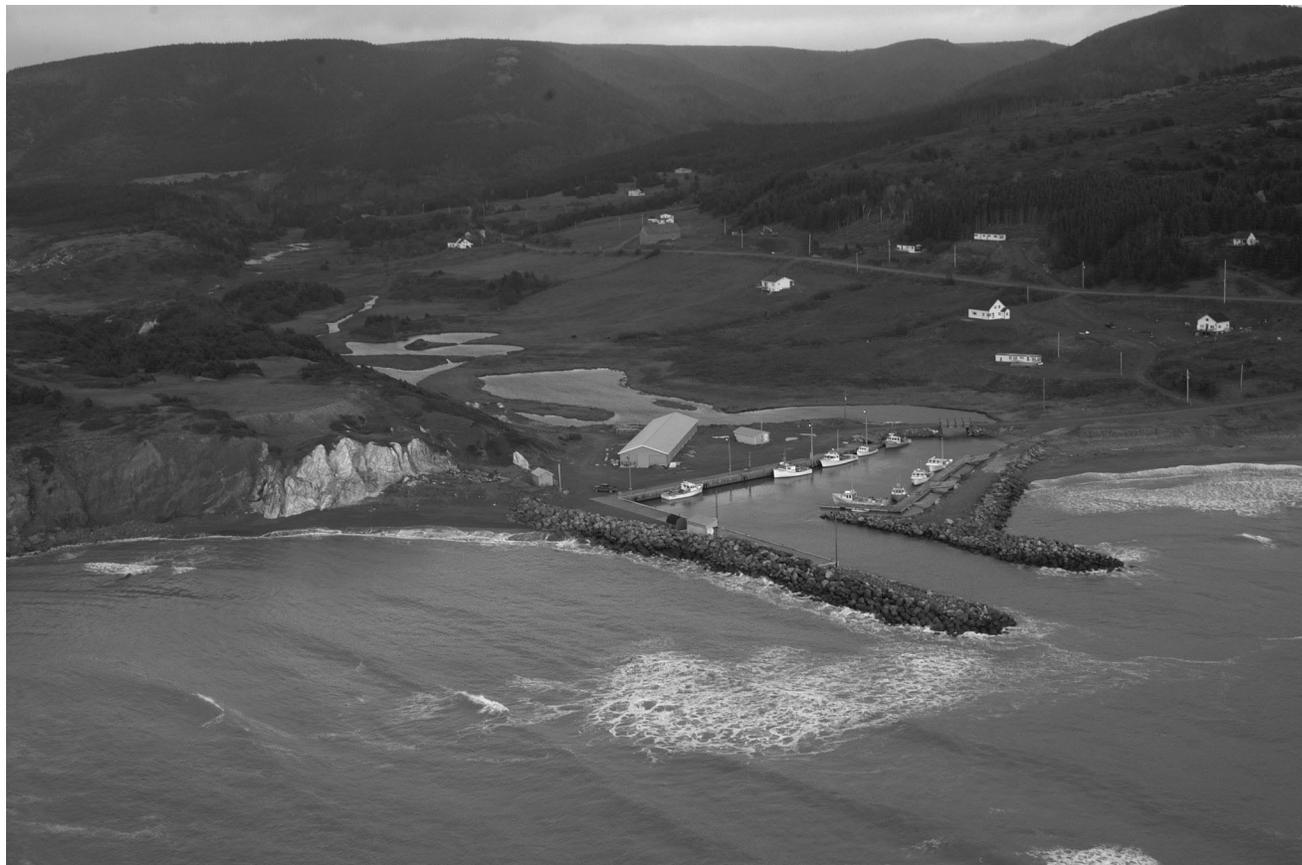
abrité par deux quais. La face externe du quai a une longueur de 105 pieds (32 m) et offre des profondeurs variant de 4 à 10 pieds (1,2 et 3 m). En 2002, les faces du bassin offraient une profondeur minimale de 5 pieds (1,5 m). Un feu (876), reposant sur une tour blanche d'une hauteur de 37 pieds (11 m), est situé à l'enracinement de ce quai.
