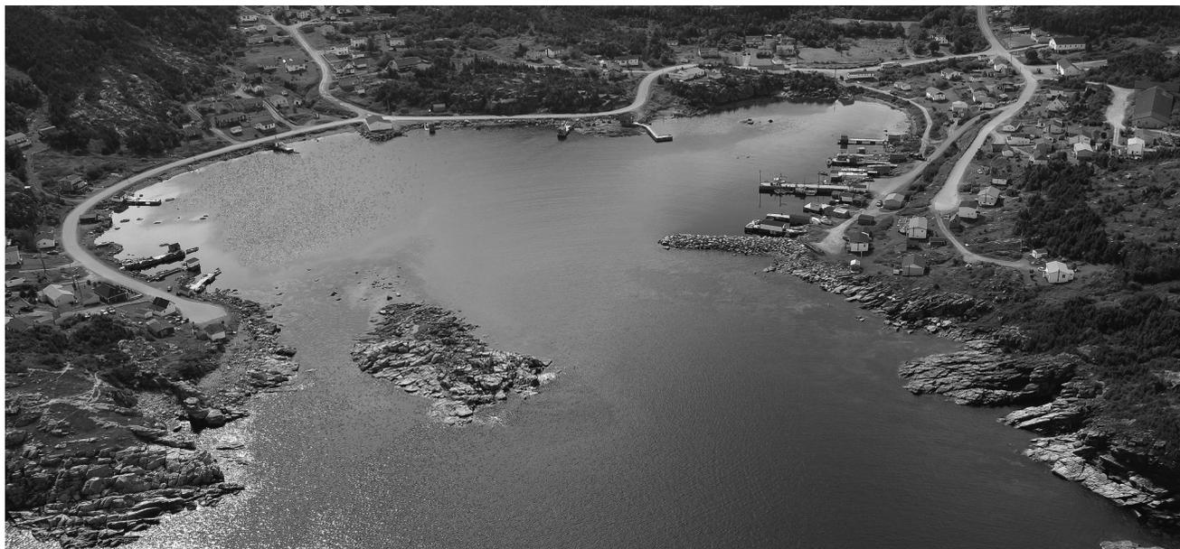
il y a un **quai** public d'une longueur de 44 m (144 pi) offrant une profondeur de 2,7 m (9 pi) le long de sa face externe de 6 m (20 pi) de large; le quai est équipé de prises d'eau. On a signalé des profondeurs de 1 à 2 m (3 à 7 pi) dans les approches du quai; la **prudence** s'impose. On a signalé que le havre est sujet à ensablement.
