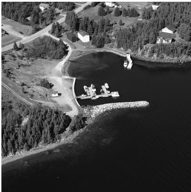
Cove. Un brise-lames enroché, qui déborde la rive dans la partie Sud de la petite anse, protège le port de plaisance. Un feu (441.49) reposant sur un mât est placé sur l'extrémité du brise-lames.
