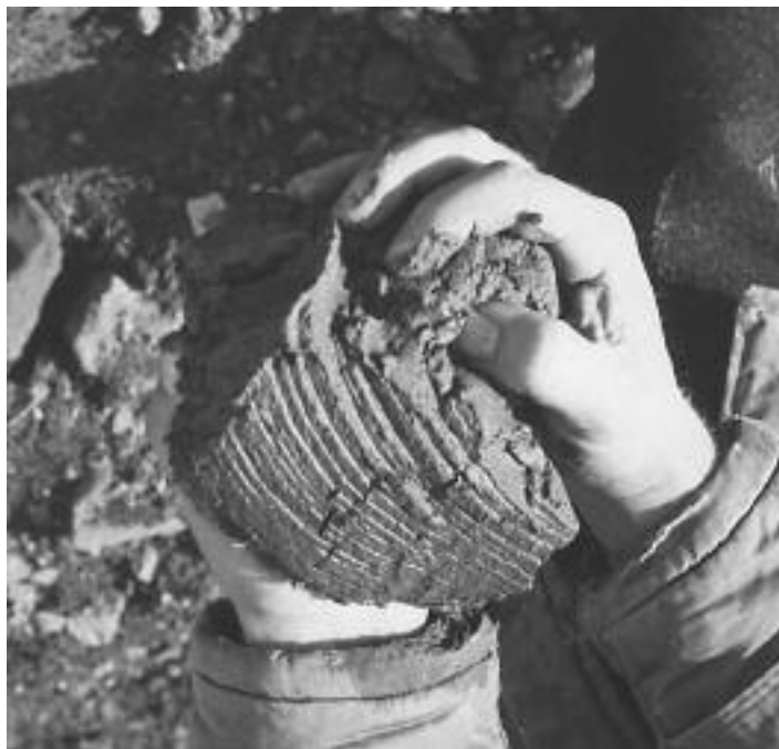
Figure 3. Échantillon de sédiments prélevé durant la construction du pont-chaussée; y apparaissent les couches déposées à chaque marée.
