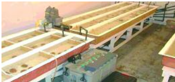
Bassins à écoulement continu utilisés dans des expériences de laboratoire visant à étudier les effets des boues de forage sur le pétoncle géant
