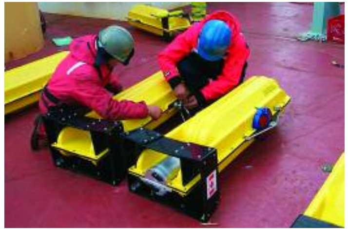
Figure 2. Préparatifs de déploiement d'un ancrage montrant des modules flottants d'instruments. On voit le profileur de courant Doppler, qui dépasse du haut de l'unité, le compas étant le cylindre argenté monté à l'arrière de celle-ci.
