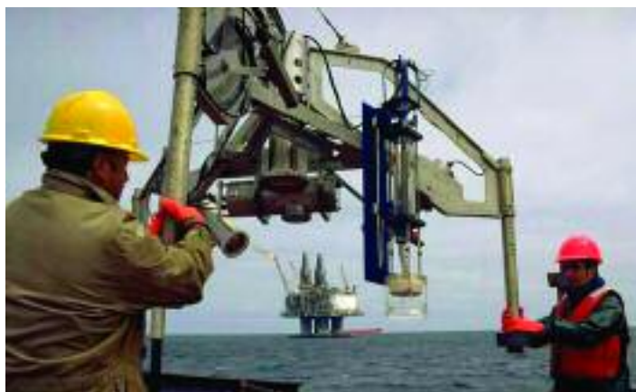
Déploiement d'un tripode destiné à être ancré au fond de l'eau pour mesurer les concentrations de sédiments et d'autres variables de la couche limite benthique près de l'installation d'Hibernia
