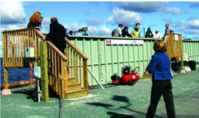
La cuve à houle servant à l'étude des agents chimiques de dispersion du pétrole à l'IOB
