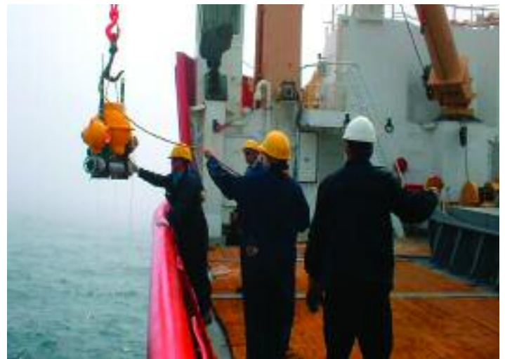
Déploiement d'un sismomètre de fond destiné à enregistrer les niveaux sonores des canons à air et les vocalisations des mammifères marins
