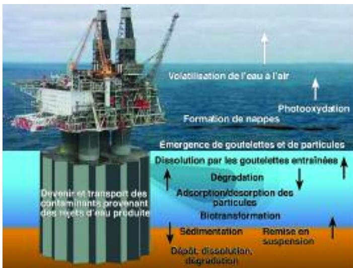
Schéma du devenir des rejets d'eau produite de la plate-forme pétrolière Hibernia et des processus connexes
