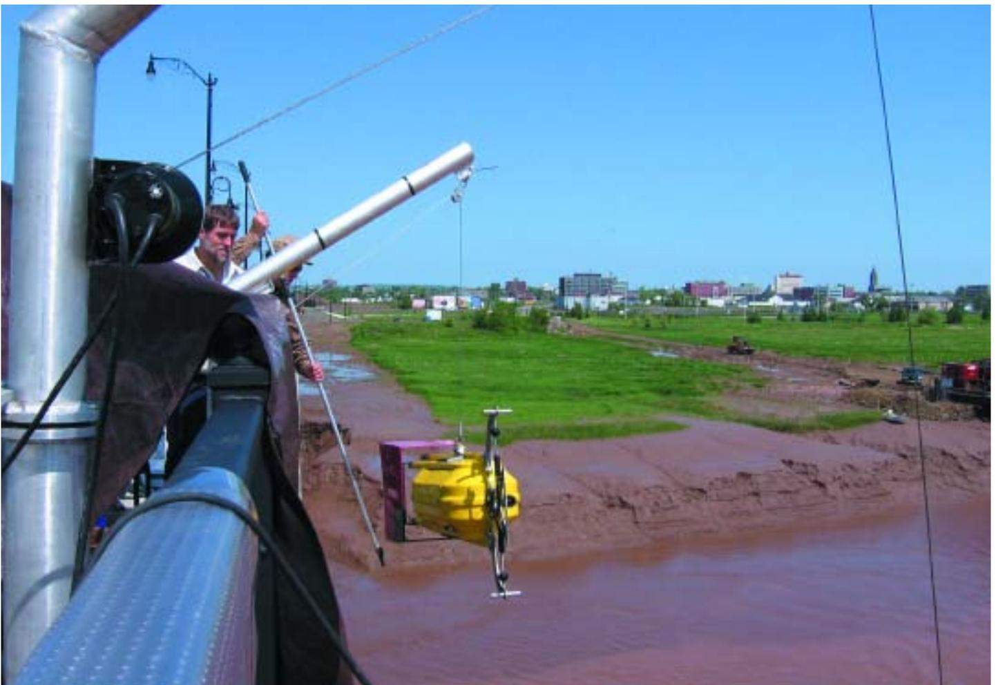
Tim Milligan et Paul Hill (derrière le bossoir) en train de mettre en place un boîtier d'instruments à partir du pont Gunningsville à Moncton (Nouveau-Brunswick) : le boîtier fuselé contient divers instruments destinés à recueillir des données sur les boues fluides dans la rivière Petitcodiac.
