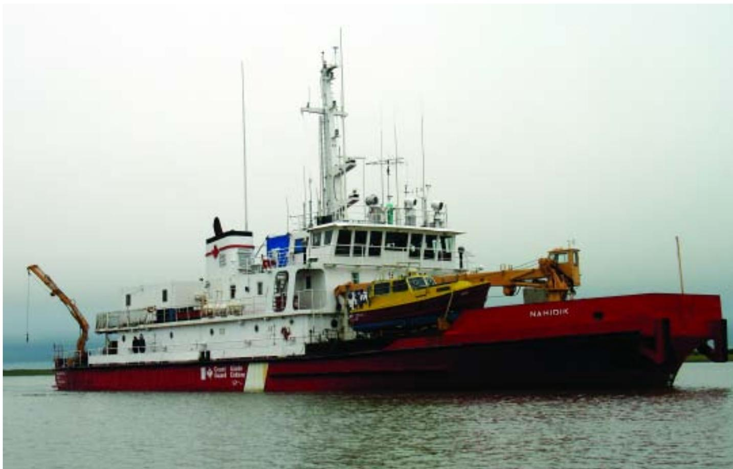
**Figure 2** Le navire scientifique NGCC *Nahidik* a une longueur de 50 m, une largeur de 15 m et un tirant d'eau de 2 m. On aperçoit la vedette de levés multifaisceaux du SHC *Petrel* sur le pont avant tribord.
