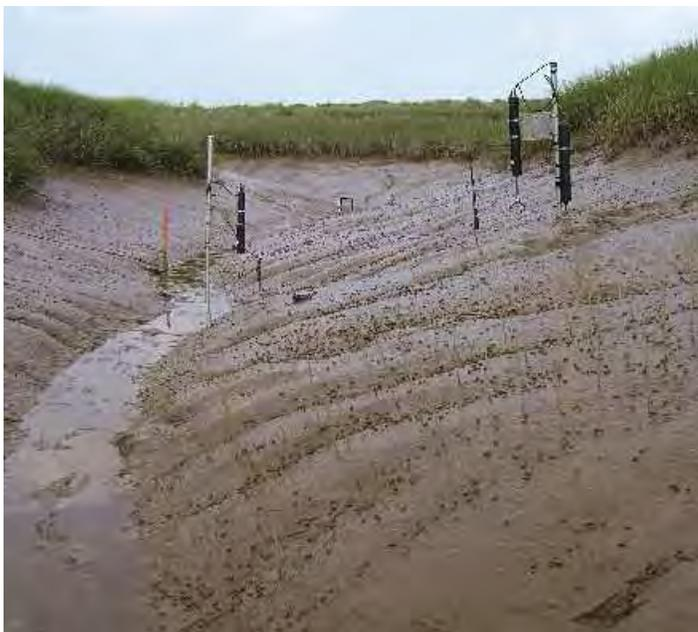
Figure 11. Dispositif d'échantillonnage des sédiments installé dans le chenal de marée de la rivière Avon, à Windsor (Nouvelle-Écosse) – Photo : M<sup>me</sup> Danika van Proosdij, Département de géographie, Université Saint Mary's
