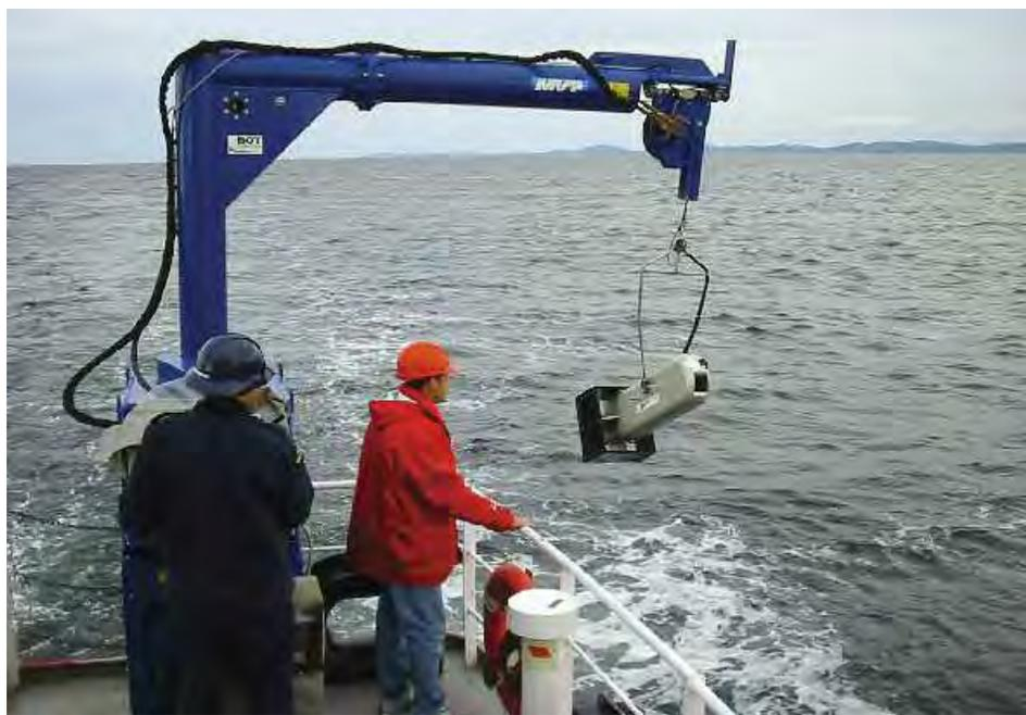
Le profileur pour navire en mouvement (Moving Vessel Profiler) MVP 200 de ODIM-Brooke Ocean à bord du NGCC *Matthew*
