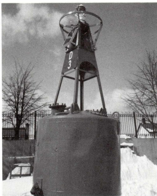
Bouées de navigation alimentées à l'énergie solaire. Observez les panneaux solaires sur le dessus et en haut de chaque bouée
